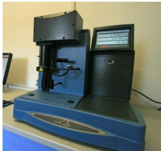
Slika 3.14. Uređaj za termogravimetrijsku analizu TGA Q500
