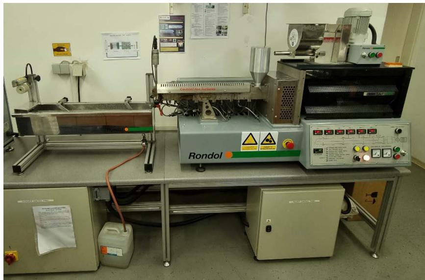
Slika 3.1. Dvopužni ekstruder Rondol 21 mm LAB TWIN
