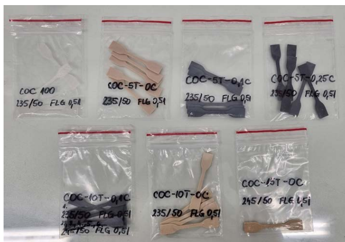
Slika 4.2. Uspješno 3D-ispisane epruvete
