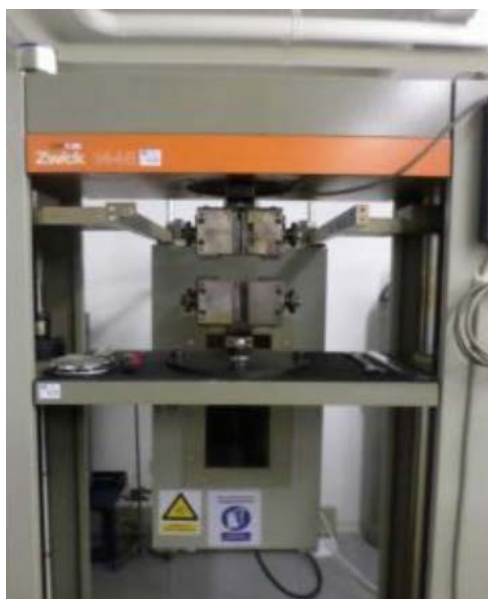
Slika 3.12. Mehanička kidalica UTM 1445 Zwick Röell, Njemačka
