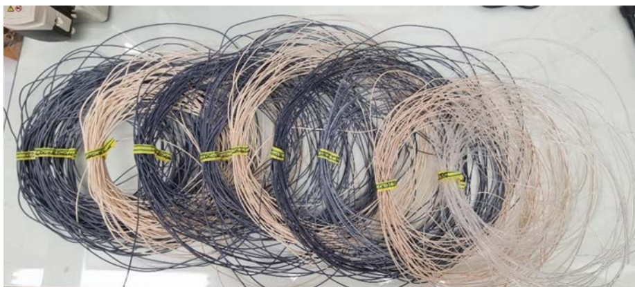
Slika 4.2. Konačni filament korišteni za 3D-ispis epruveta
