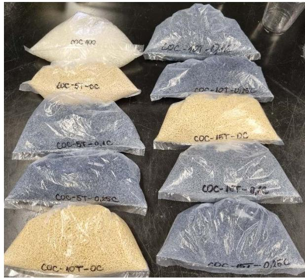
Slika 3.4. Granule ekstrudata nakon sjeckanja u granulatoru
