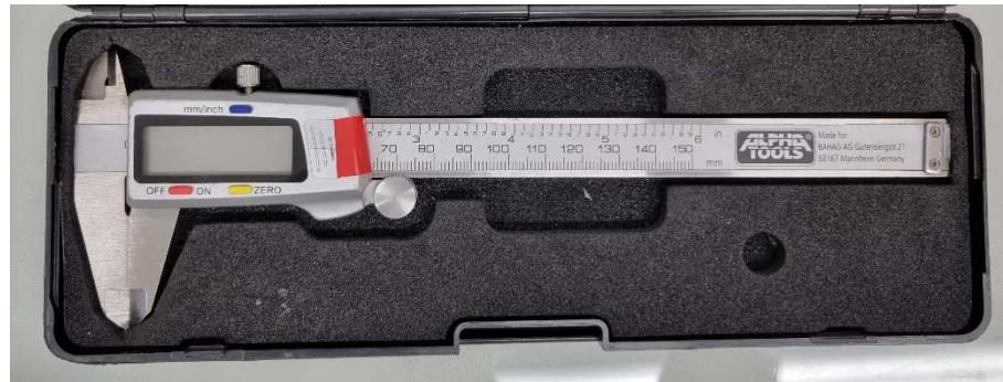
Slika 3.6. Pomična mjerka (pomično mjerilo)
