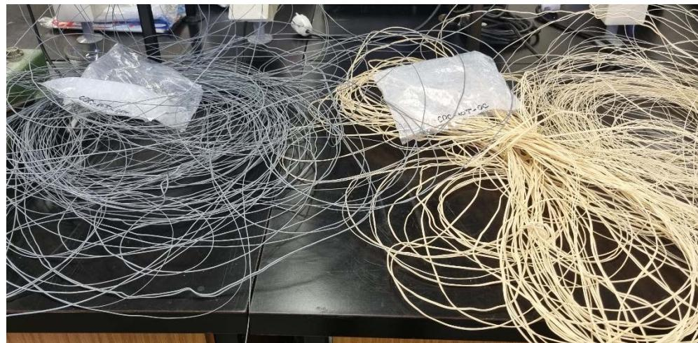
Slika 3.2. Dobiveni ekstrudati sa punilom CNT (sivi)
