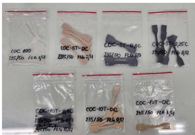
Slika 4.2. Uspješno 3D-ispisane epruvete
