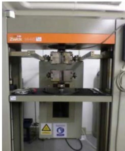
Slika 3.12. Mehanička kidalica UTM 1445 Zwick Röell, Njemačka
