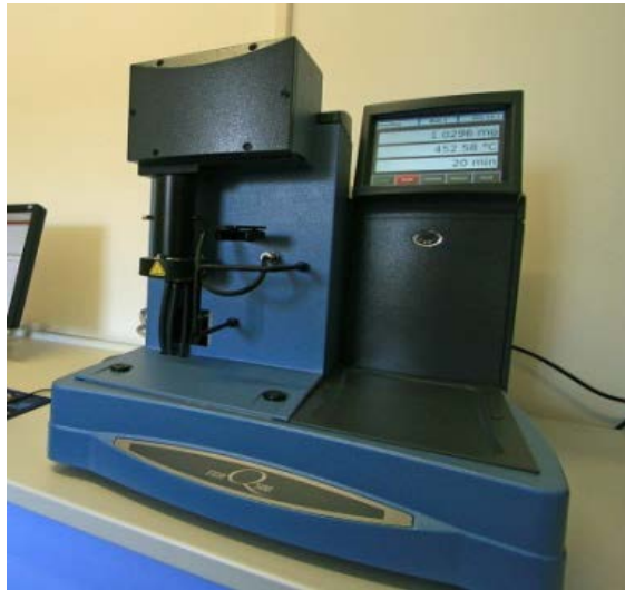
Slika 3.14. Uređaj za termogravimetrijsku analizu TGA Q500
