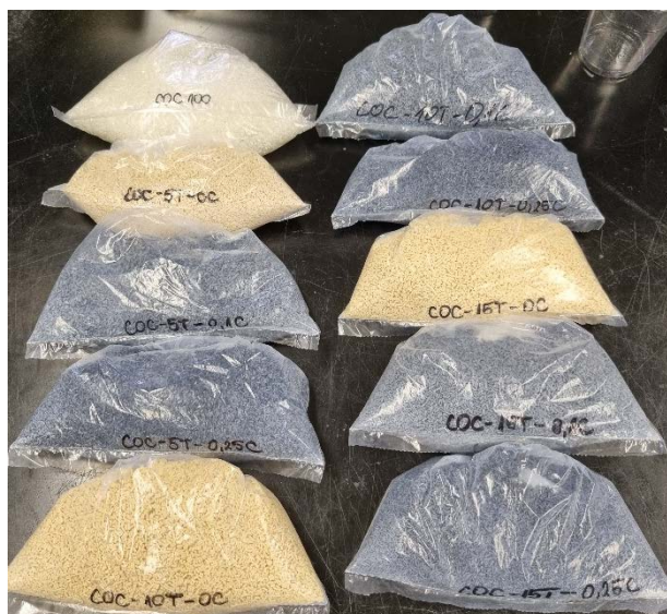
Slika 3.4. Granule ekstrudata nakon sjeckanja u granulatoru
