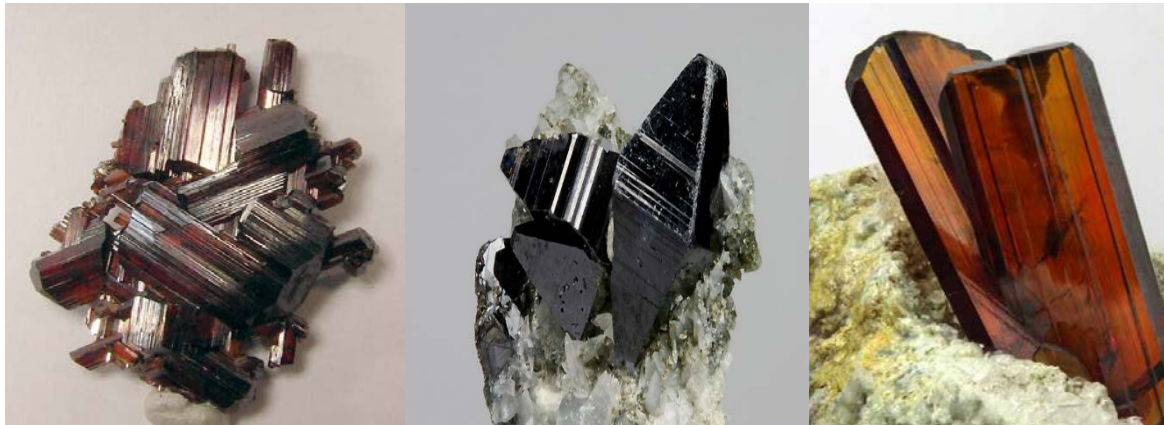
Slika 2.8. Polimorfne modifikacije \text{TiO}_2 : rutil, anatas, brukit 21,22,23
