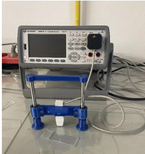
Slika 3.7. Uređaj za mjerenje otpora rGO papira
