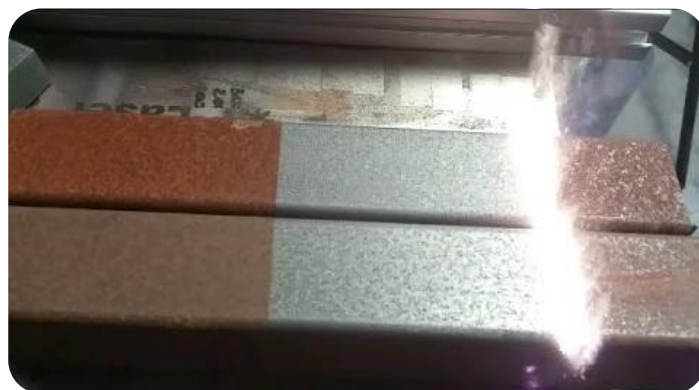
Slika 22. lasersko uklanjanje površinske hrđe s čelika [21]
