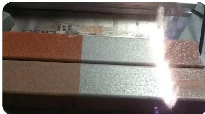
Slika 22. lasersko uklanjanje površinske hrđe s čelika [21]
