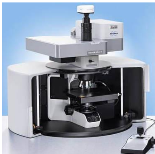
Slika 11. Uređaj za lasersku spektroskopiju [16]
