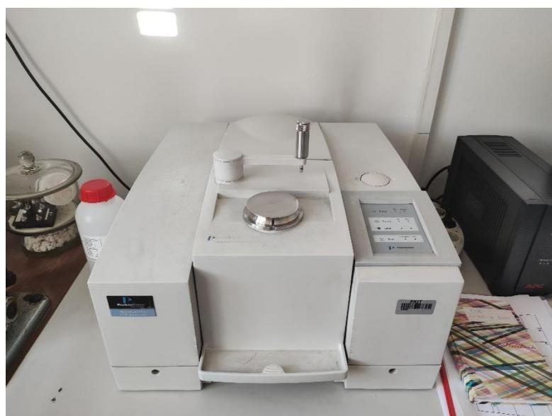
Slika 15. FTIR spektrometar PerkinElmer, Spectrum One
