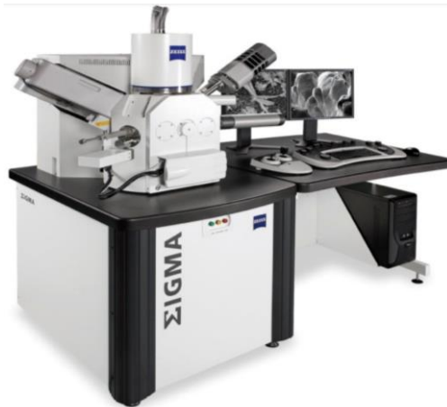
Slika 19. Pretražni elektronski mikroskop s emisijom polja. [36]
