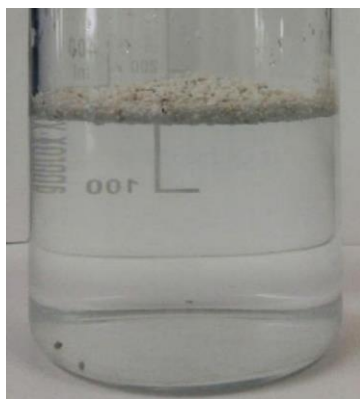
Slika 15. Plutanje perlita na površini vode. [30]
