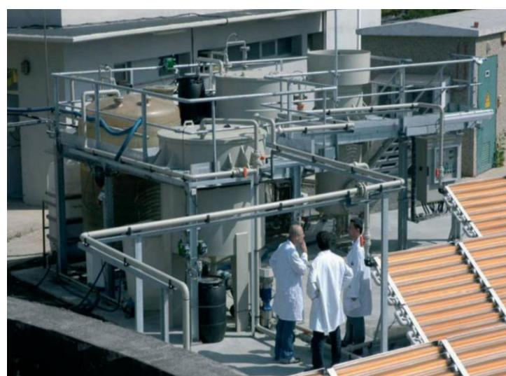
Slika 6. Oprema za biološku obradu otpadne vode pri Fentonovoj oksidaciji. [8]
