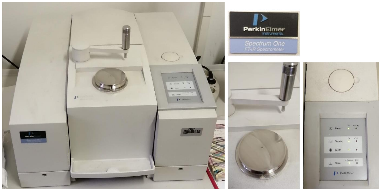
Slika 12. Perkin Elmer Spectrum One FT-IR Spectrometer
