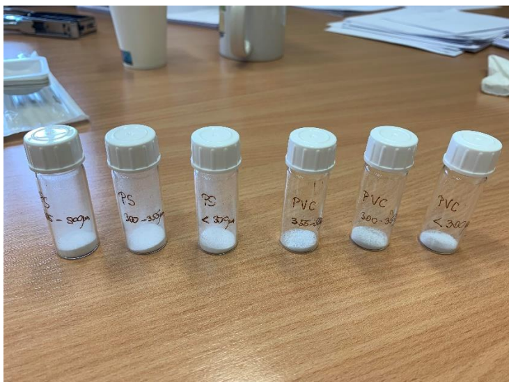
Slika 16. Uzorci mikroplastičnih čestica polivinil klorida (PVC) te polistirena (PS) u rasponu od <300\text{-}500\ \mu\text{m} korištenih u eksperimentu
