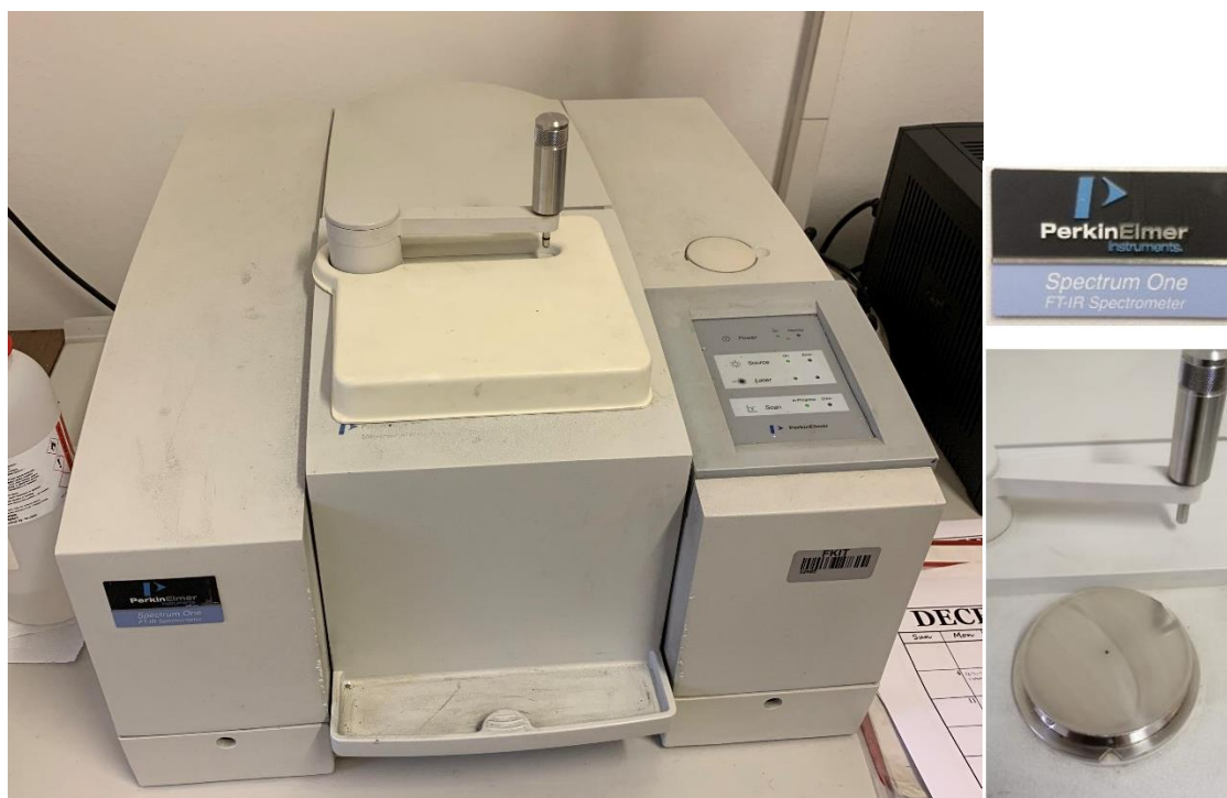
Slika 21. Uređaj Perkin Elmer Spectrum One FT-IR Spectrometer
