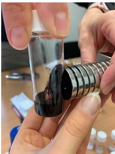
Slika 20. Pripremljeni ferrofluid korišten u eksperimentalnom dijelu
