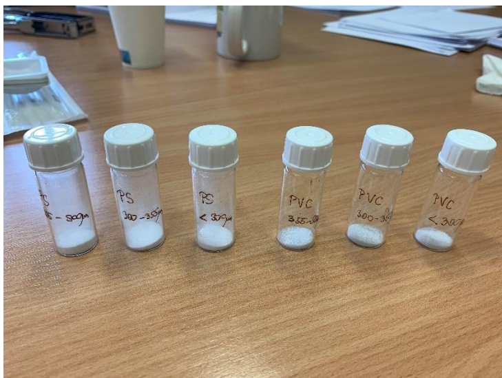
Slika 16. Uzorci mikroplastičnih čestica polivinil klorida (PVC) te polistirena (PS) u rasponu od <300-500 \mu\text{m} korištenih u eksperimentu
