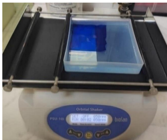
Slika 22. a) Bojanje gela na orbitalnoj tresilici u digestoru, b) odbojavanje gela na orbitalnoj tresilici u digestoru
