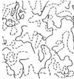
Slika 5. Mješljiva mješavina polimera A (puna linija) i polimera B (iscrtkana linija) [6]
