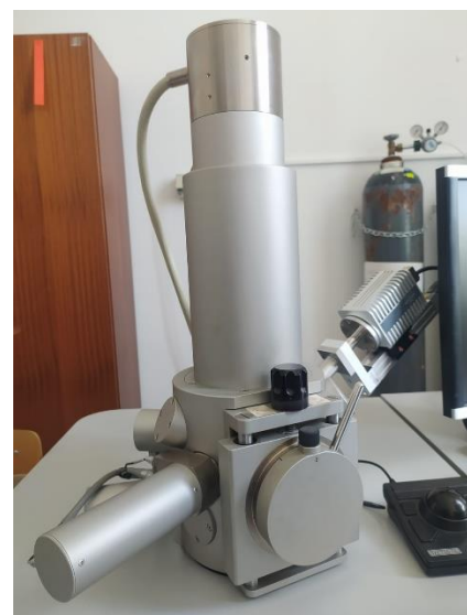
Slika 18. Uređaj za neparivanje uzoraka s vodljivim slojem zlata (lijevo), pretražni elektronski mikroskop Tesca Vega serije 3, Bruker (desno)
