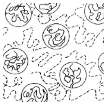
Slika 7. Nemješljiva mješavina polimera A (puna linija) i polimera B (iscrtkana linija) [6]
