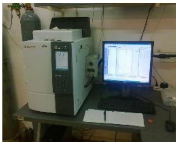
*Slika 25.* GC - *Shimadzu GC-2014* (CIL, INA d.d.)
