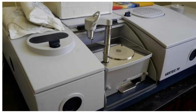
*Slika 24.* Uređaj za FTIR analizu- *Bruker Vertex 70*
