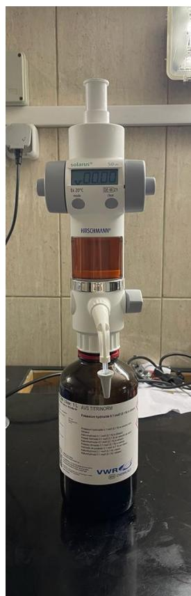
**Slika 17.** Aparatura za titraciju (poluautomatska bireta)
