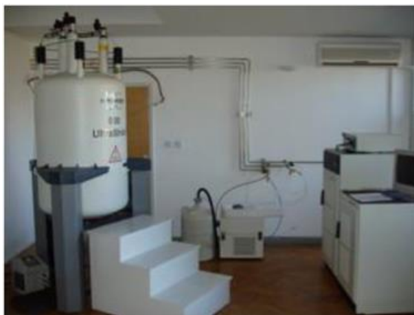
Slika 23. ^1\text{H} NMR Spektrometar Bruker Avance 300 (CIL, INA d.d.)
