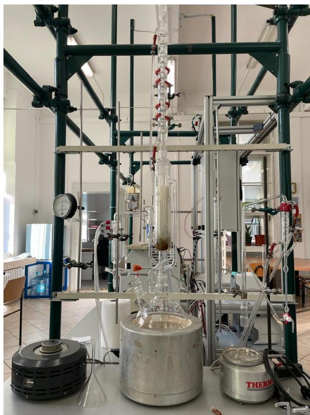
**Slika 16.** Soxhlet aparatura koja je korištena u laboratoriju
