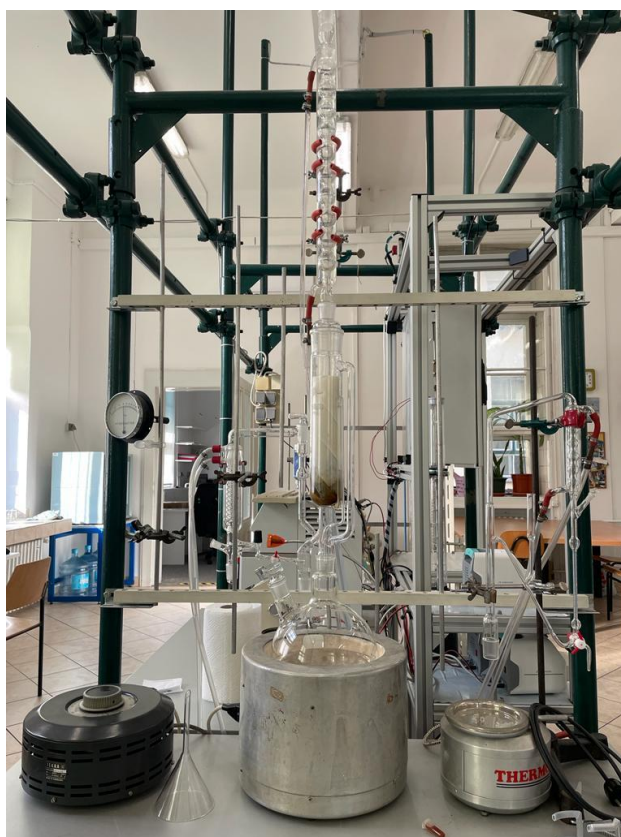
Slika 16. Soxhlet aparatura koja je korištena u laboratoriju
