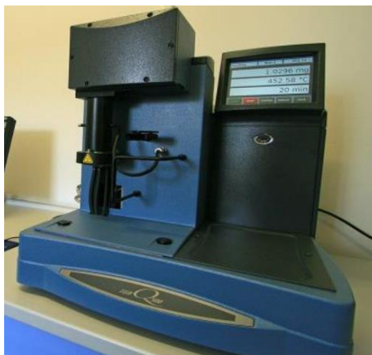
Slika 9. Temogravimetrijski analizator Q 500, TA instruments
