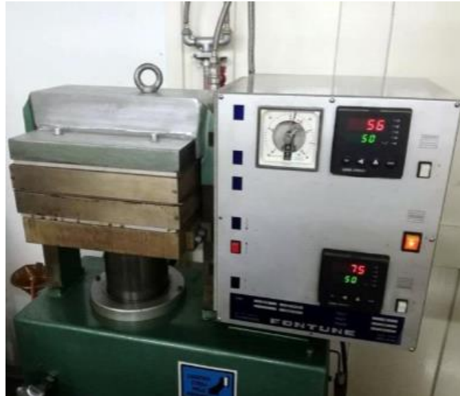
Slika 7. Hidraulična preša Fortune Holland
