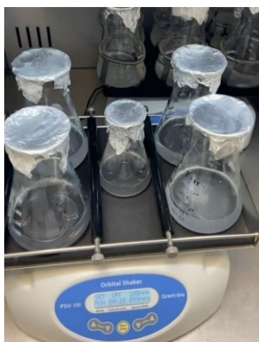
Slika 3.9. Prikaz provedbe pokusa na tresilici u termostatu pri 15°C.
