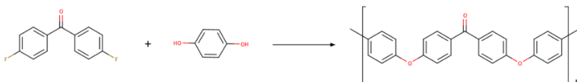
Slika 3. Reakcija proizvodnje PEEK-a
