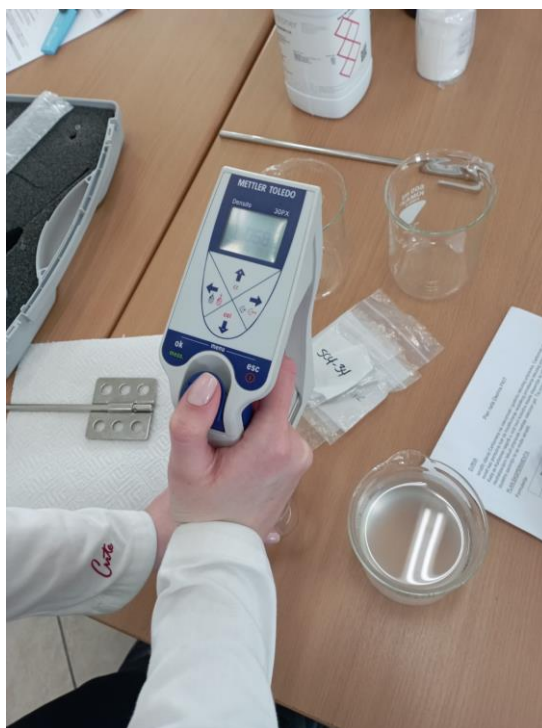
Slika 9. Mjerenje gustoće pomoću denzitometra
