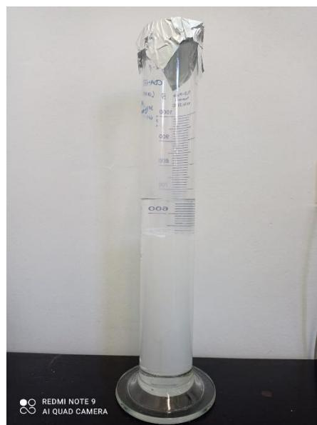
Slika 7. Skladištenje membrana u menzuru s deioniziranom vodom
