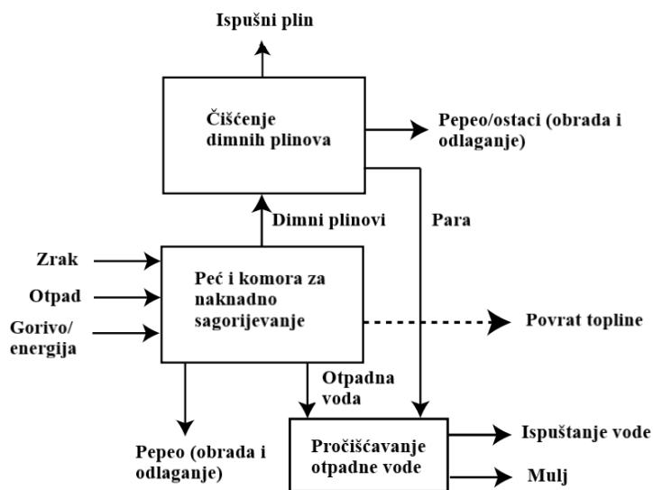
**Slika 10.** Pojednostavljena shema toka procesa spaljivanja [30]
