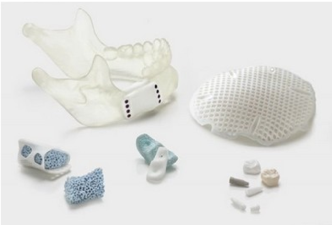
Slika 7. Okosnice proizvedene SLA postupkom za primjene u inženjerstvu koštanog tkiva (Lithoz) [7].
