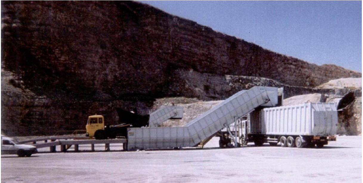
Slika 25. Utovar otpada u poluprikolicu s potisnom pločom
