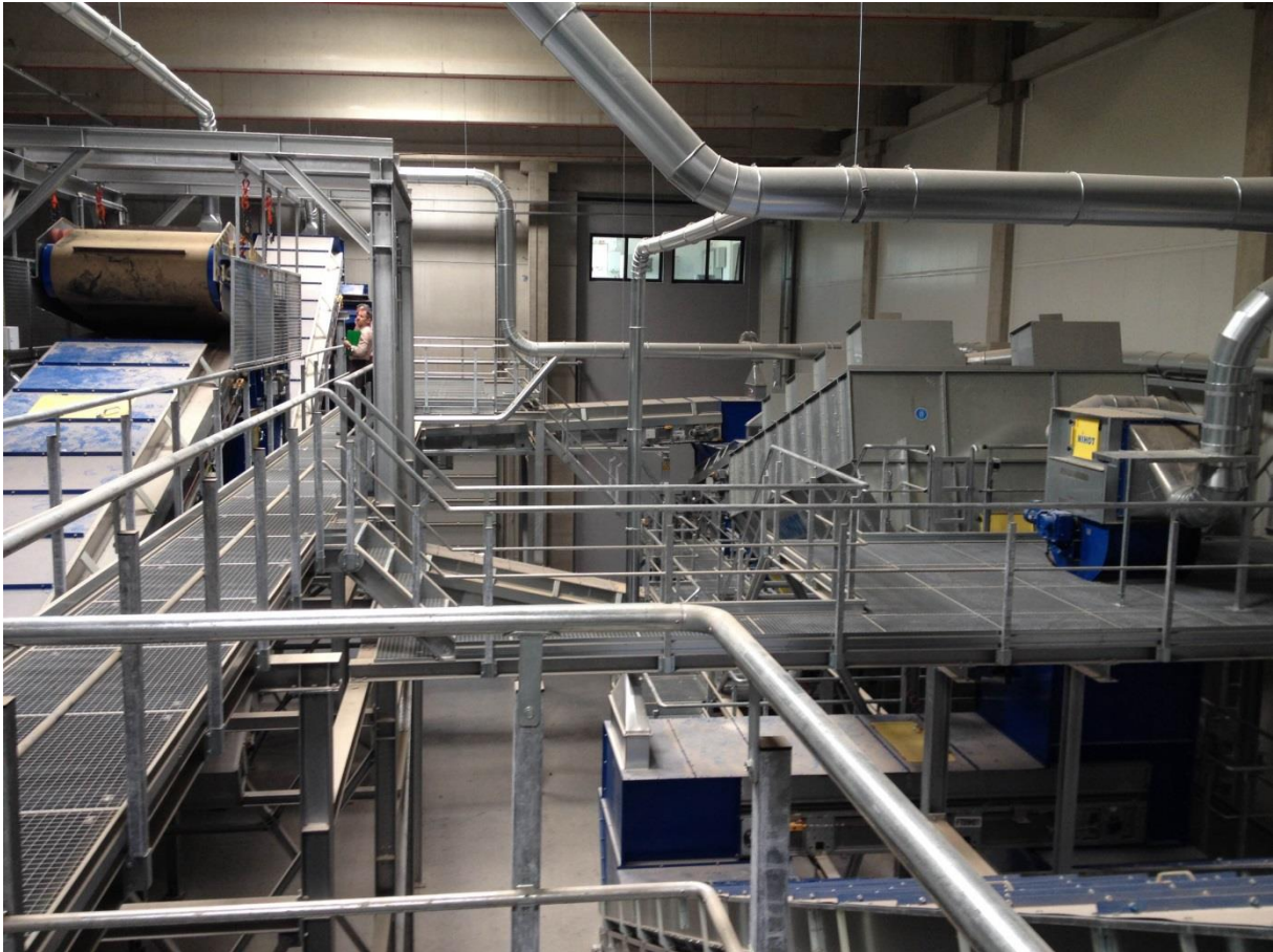
Slika 30. Prikaz uređaja za mehaničku obradu otpada (lijevo – magnetski separator, desno – separator lake i teže frakcije otpada)
