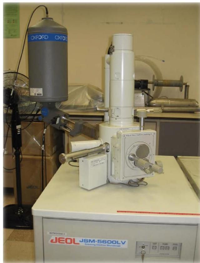
**Slika 2.18.** Pretražni elektronski mikroskop JSM-5600LV
