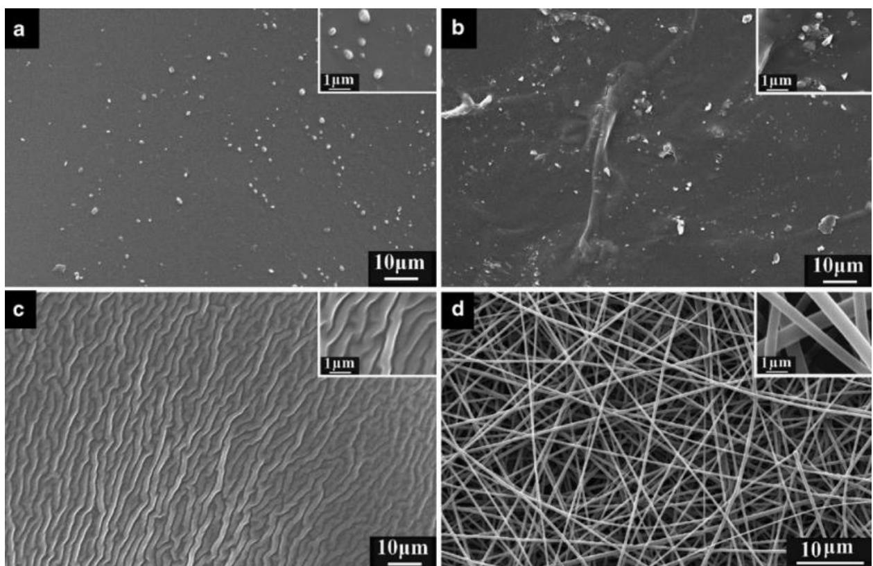
**Slika 2.20.** Slika membrana pripravljenih različitim postupcima dobivena SEM-om : (a) toplinako sušenje, (b) vakuumsko sušenje, (c) sušenje zamrzavanjem, (d) elektroispredanjem.
