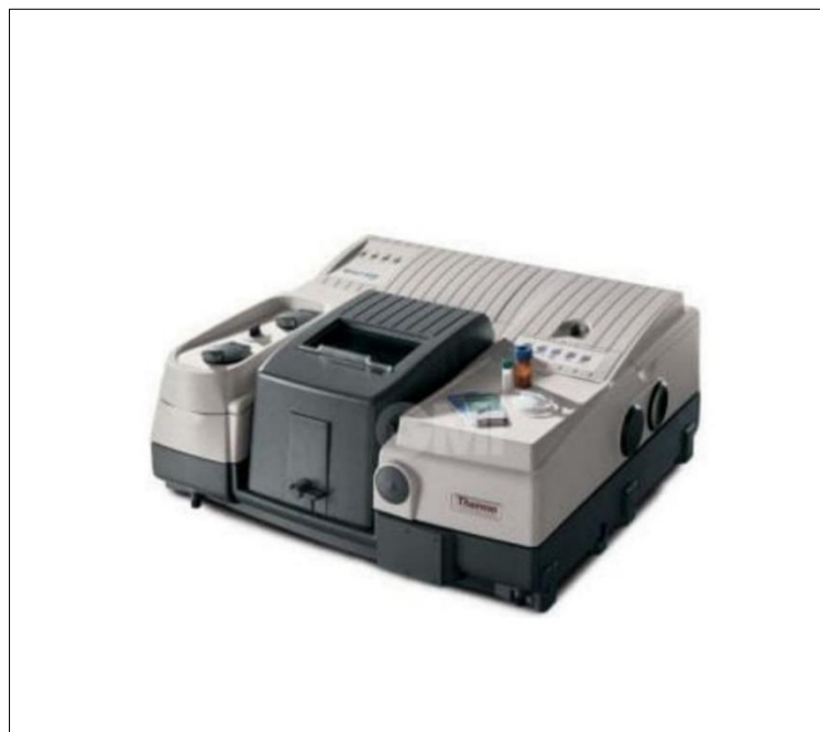
Slika 2.19. Infracrveni spektrometar Nicolet-Nexus 670
