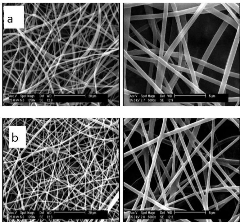
**Slika 2.13.** Slika nanovlakana kefirana/PVA dobivena SEM mikroskop pri različitim naponima: (a) 15 kV, (b) 18 kV.
