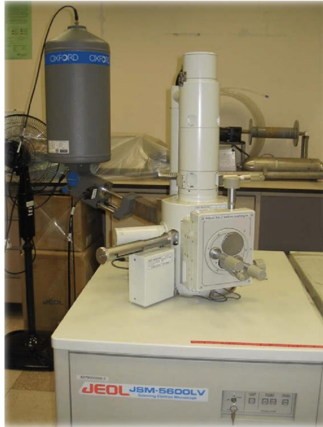
Slika 2.18. Pretražni elektronski mikroskop JSM-5600LV
