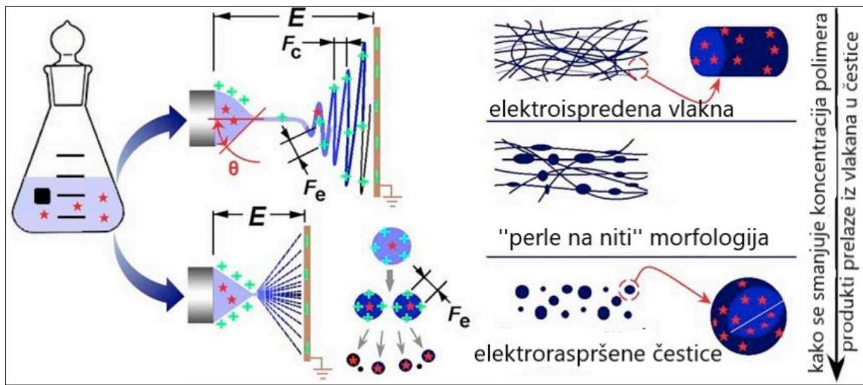
**Slika 2.17.** Shematski prikaz procesa elektroispredanja i elektroraspršivanja
