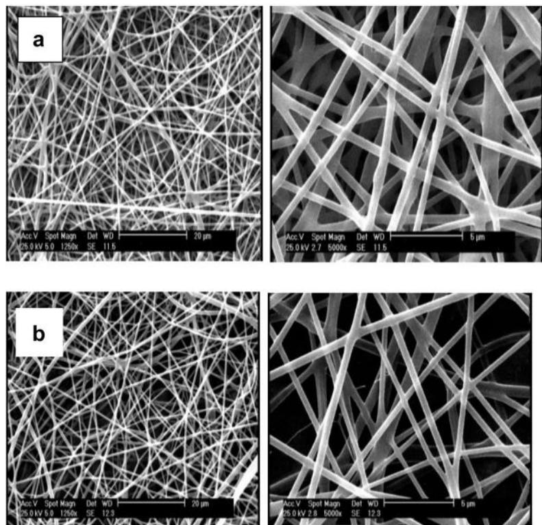
**Slika 2.14.** Slika nanovlakana kefran/PVA dobivena SEM mikroskopom u razlicitim udaljenostima mlaznice od kolektora: (a) 120, (b) 150.
