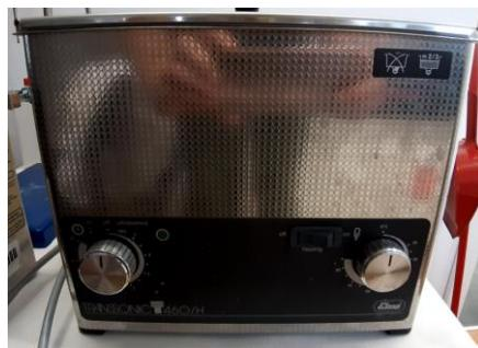
**Slika 7.** Ultrazvučna kupelj Elma Transsonic, 460H.
