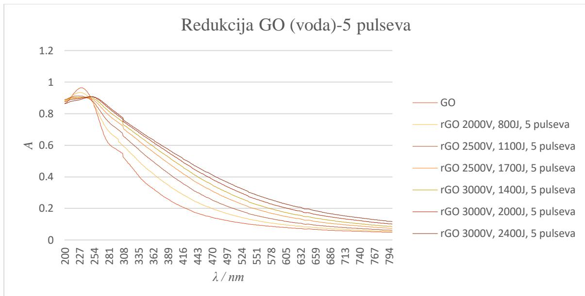
**Slika 11.** UV-Vis spektari grafen oksida dispergiranog u vodi izloženog seriji od 5 pulseva intenzivne pulsirajuće svjetlosti.
