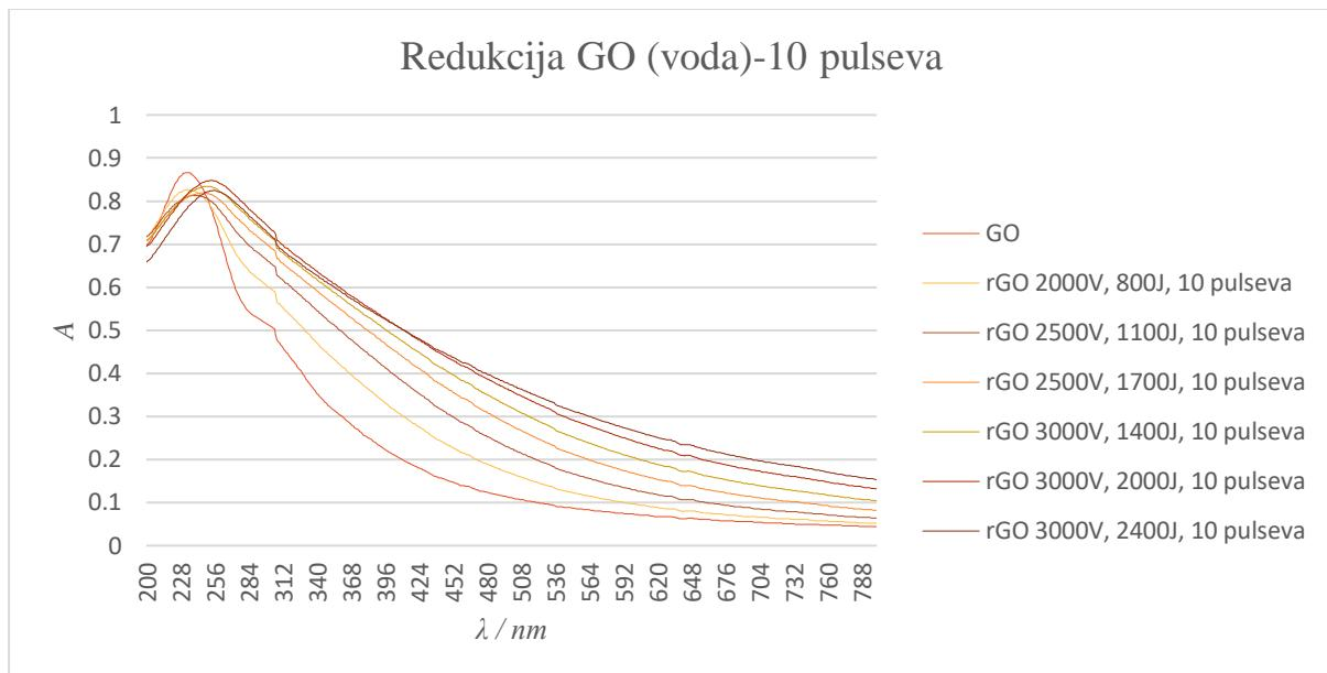
**Slika 12.** UV-Vis spektar redukcije grafen oksida dispergiranog u vodi i izloženog seriji od 10 pulseva intenzivne pulsirajuće svjetlosti.
