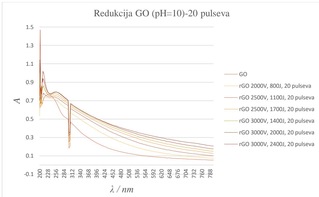
**Slika 21.** UV-Vis spektri redukcije grafen oksida dispergiranog u puferu pH= 10 i izloženog seriji od 20 pulseva intenzivne pulsirajuće svjetlosti.
