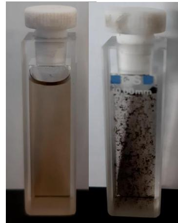
**Slika 14.** Grafen oksid dispergiran u vodi prije i nakon izlaganja seriji od **a)** 5 pulseva,  $U=3000\text{V}$ ,  $E=2400\text{J}$  **b)** 10 pulseva,  $U=3000\text{V}$ ,  $E=2400\text{J}$  **c)** 20 pulseva,  $U=3000\text{V}$ ,  $E=2400\text{J}$  IPL-a.
