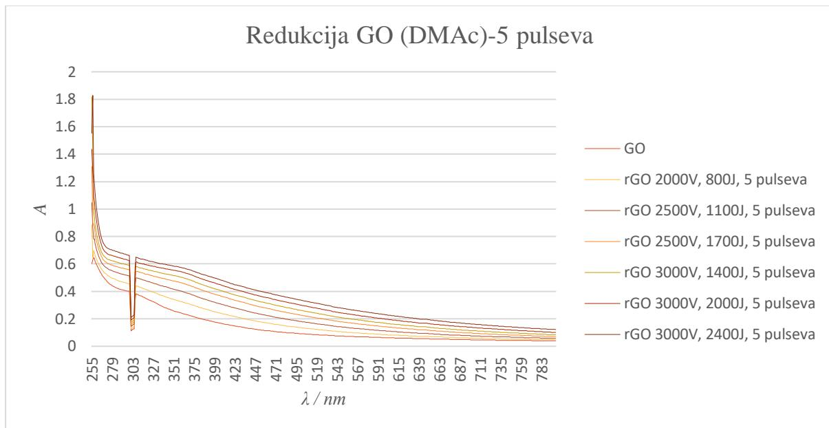
**Slika 23.** UV-Vis spektri redukcije grafen oksida dispergiranog u smjesi DMAc i vode te izloženog seriji od 5 pulseva intenzivne pulsirajuće svjetlosti.
