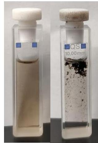
**Slika 18.** Grafen oksid dispergiran u etanolu prije i nakon izlaganja seriji od **a)** 5 pulseva,  $U=3000\text{V}$ ,  $E=2400\text{J}$  **b)** 10 pulseva,  $U=3000\text{V}$ ,  $E=2400\text{J}$  **c)** 20 pulseva,  $U=3000\text{V}$ ,  $E=2400\text{J}$  IPL-a
