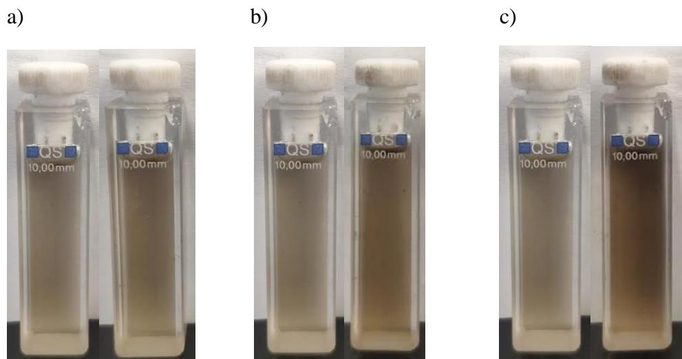
**Slika 26.** Grafen oksid dispergiran u smjesi DMAc-a i vode prije i nakon izlaganja seriji od **a)** 5 pulseva,  $U=3000V$ ,  $E=2400J$  **b)** 10 pulseva,  $U=3000V$ ,  $E=2400J$  **c)** 20 pulseva,  $U=3000V$ ,  $E=2400J$  IPL-a
