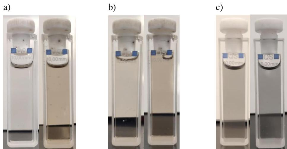
**Slika 30.** Grafen oksid dispergiran u etanolu i stabiliziranog polivinil butiralom u prije i nakon izlaganja seriji od **a)** 5 pulseva, U=3000V, E=2400J **b)** 10 pulseva, U=3000V, E=2400J **c)** 20 pulseva, U=3000V, E=2400J IPL-a
