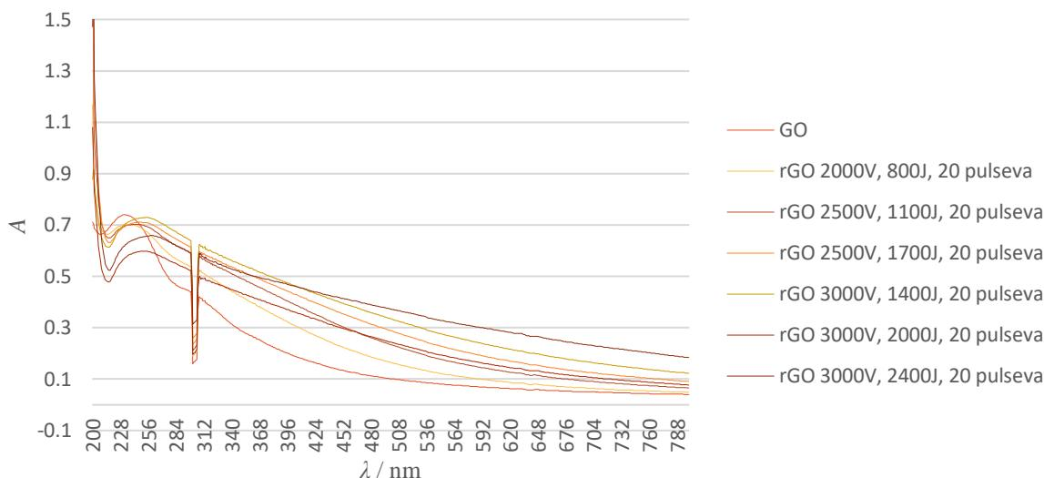
**Slika 29.** UV-Vis spektri redukcije grafen oksida dispergiranog u etanolu i stabiliziranog polivinil butiralom te izloženog seriji od 20 pulseva intenzivne pulsirajuće svjetlosti.
