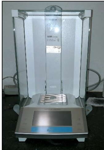
Slika 5. Analitička vaga proizvođača Mettler Toledo XA105 DualRange.
