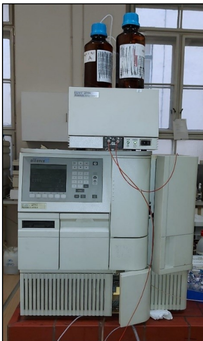
Slika 7. Tekućinski kromatograf visoke učinkovitosti Waters 2795 Alliance.
