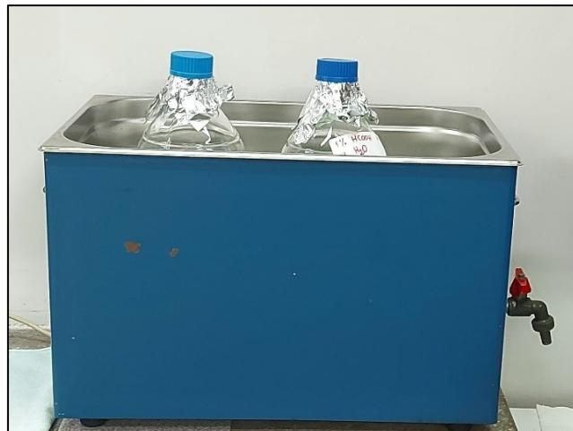
*Slika 8. Ultrazvučna kada proizvođača Iskra.*
