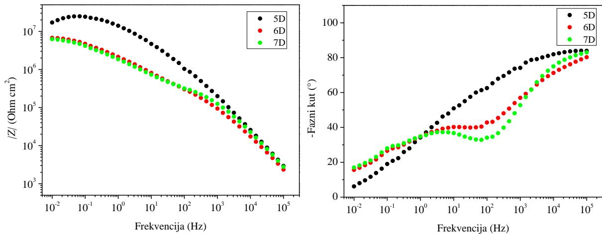
**Slika 47.** Bodeov dijagram za Paraloid u debljem sloju sa debljim hidrogelovima sa limunskom kiselinom u dvoeleketrodnom sustavu sa Pt elektrodom
