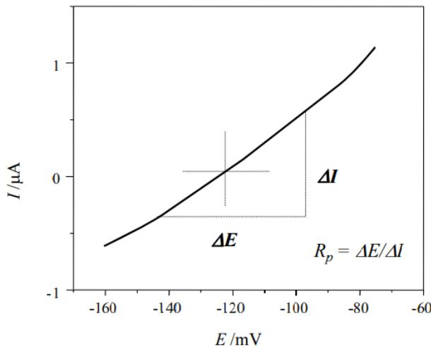
**Slika 3.** Linearna polarizacija (određivanje polarizacijskog otpora) [2]
