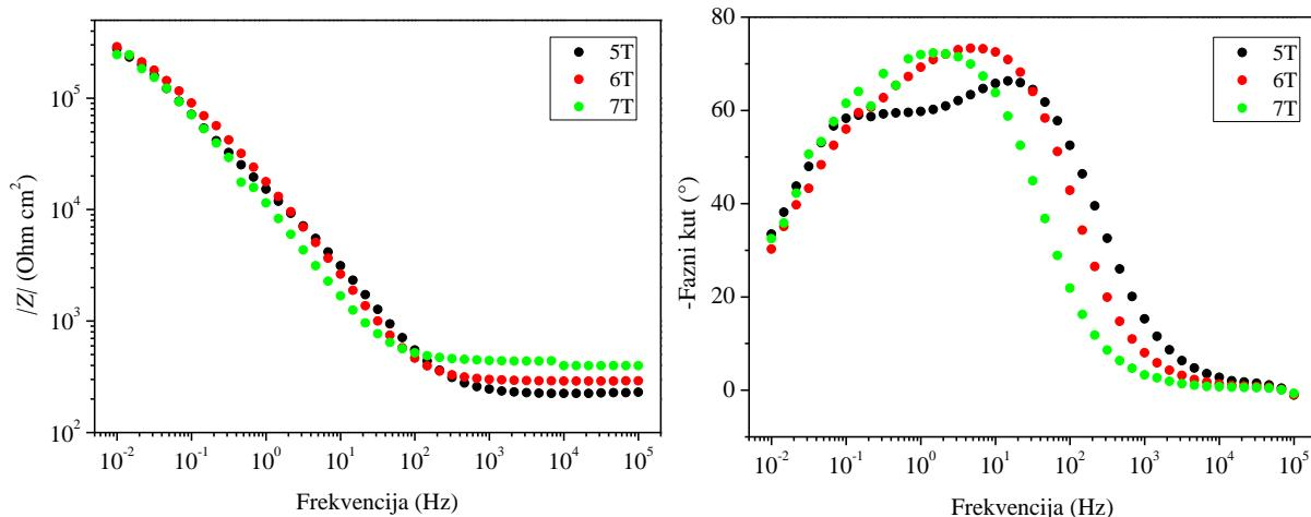
**Slika 37.** Bodeov dijagram za sulfidnu patinu sa tanjim hidrogelovima sa limunskom kiselinom u dvoelektrodnom sustavu sa Pt elektrodom
