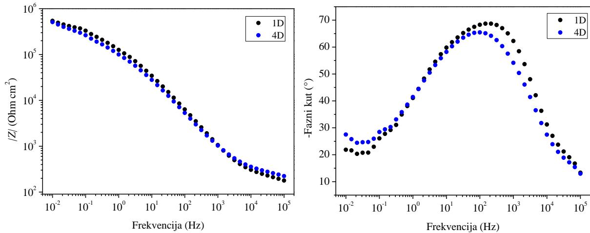
**Slika 51.** Bodeov dijagram za Paraloid u tanjem sloju sa debljim hidrogelovima sa umjetnom kišom u dvoelektrodnom sustavu sa Pt elektrodom
