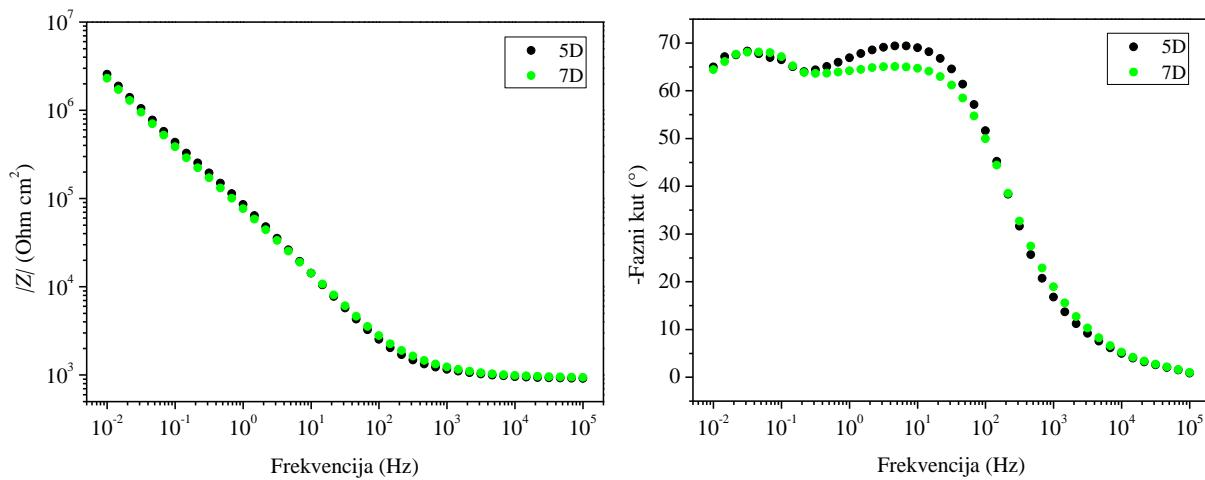
**Slika 54.** Bodeov dijagram za Paraloid u tanjem sloju sa debljim hidrogelovima sa limunskom kiselinom u dvoeleketrodnom sustavu sa polimernom elektrodom
