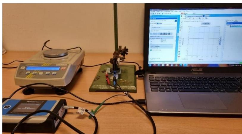
*Slika 10.* Aparatura za EIS mjerjenje u dvoelektrondnom sustavu sa hidrogelom
