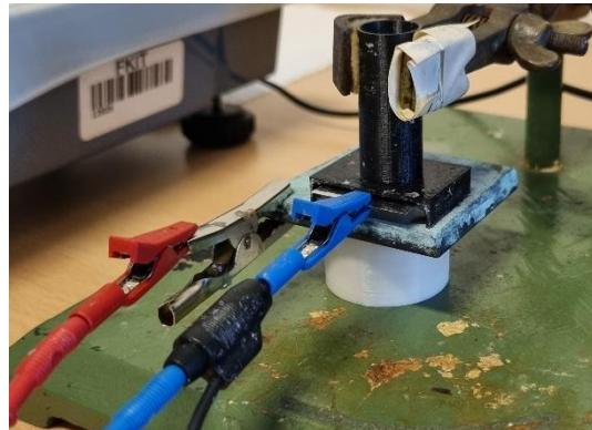
*Slika 9.* Dvoelektrondni sustav sa hidrogelom i Pt elektrodom
