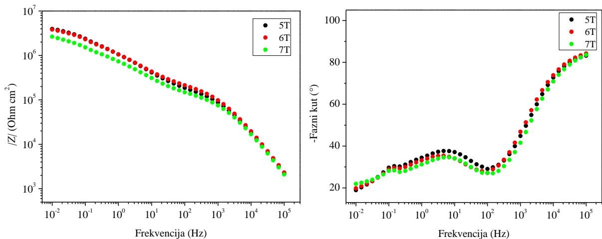
**Slika 49.** Bodeov dijagram za Paraloid u debljem sloju sa tanjim hidrogelovima sa limunskom kiselinom u dvoeleketrodnom sustavu sa Pt elektrodom
