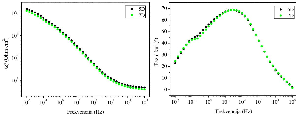
**Slika 55.** Bodeov dijagram za Paraloid u tanjem sloju sa debljim hidrogelovima sa limunskom kiselinom u dvoeleketrodnom sustavu sa Pt elektrodom
