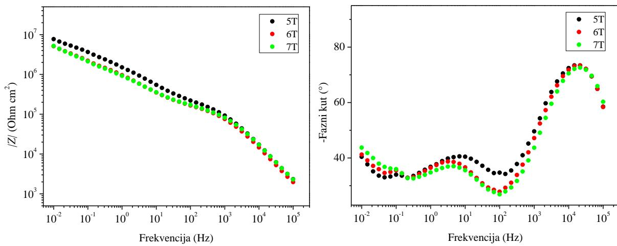
**Slika 48.** Bodeov dijagram za Paraloid u debljem sloju sa tanjim hidrogelovima sa limunskom kiselinom u dvoeleketrodnom sustavu sa polimernom elektrodom
