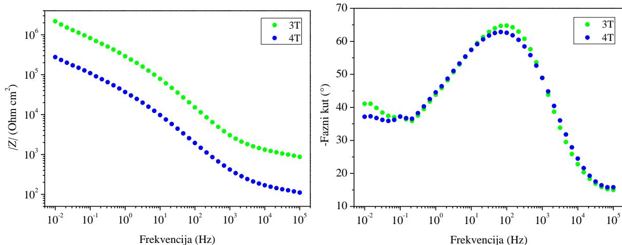
**Slika 53.** Bodeov dijagram za Paraloid u tanjem sloju sa tanjim hidrogelovima sa umjetnom kišom u dvoelektrodnom sustavu sa Pt elektrodom
