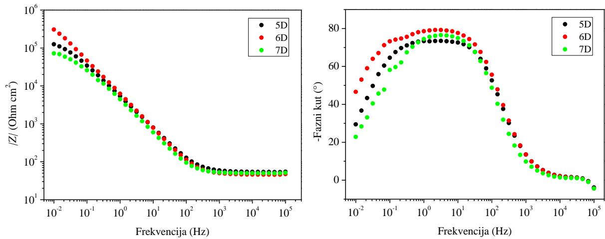
**Slika 35.** Bodeov dijagram za sulfidnu patinu sa debljim hidrogelovima sa limunskom kiselinom u dvoeleketrodnom sustavu sa Pt elektrodom
