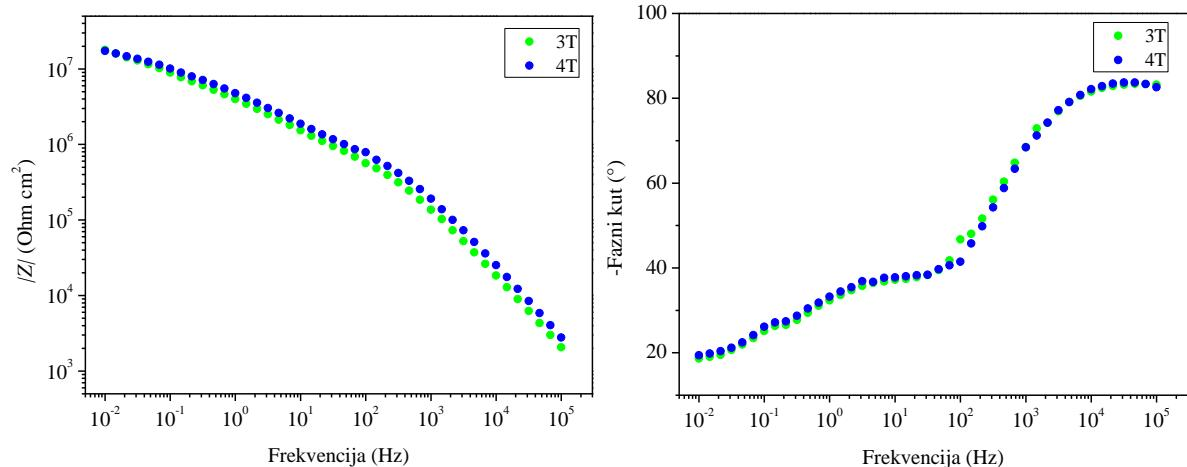
**Slika 45.** Bodeov dijagram za Paraloid u debljem sloju sa tanjim hidrogelovima sa umjetnom kišom u dvoelektrodnom sustavu sa Pt elektrodom
