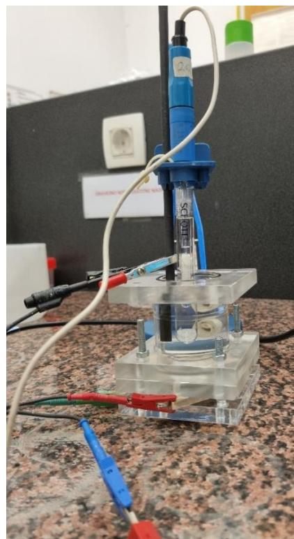
**Slika 12.** Troelektrodna elektrokemijska ćelija sa tekućim elektrolitom
