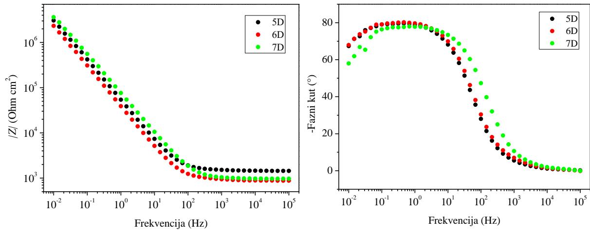
**Slika 34.** Bodeov dijagram za sulfidnu patinu sa debljim hidrogelovima sa limunskom kiselinom u dvoeleketrodnom sustavu sa polimernom elektrodom
