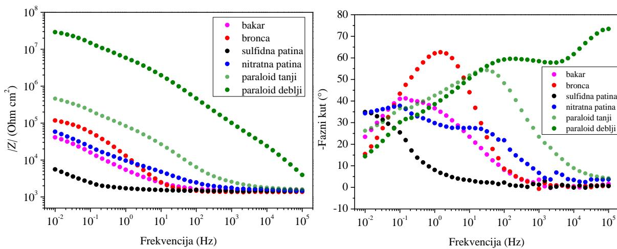
**Slika 58.** Bodeov dijagram za troelektrodni sustav sa tekućim elektrolitom
