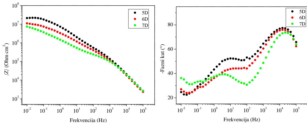
**Slika 46.** Bodeov dijagram za Paraloid u debljem sloju sa debljim hidrogelovima sa limunskom kiselinom u dvoeleketrodnom sustavu sa polimernom elektrodom
