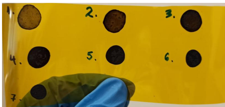
Slika 52. Tanki filmovi na poliimidu nakon sušenja na grijaču.
