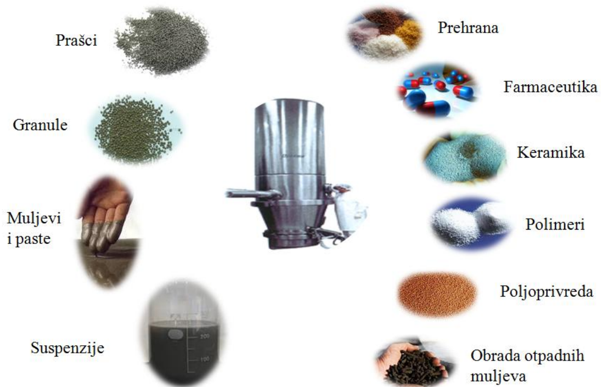
Slika 9. Industrijska primjena procesa s fluidiziranim slojem
