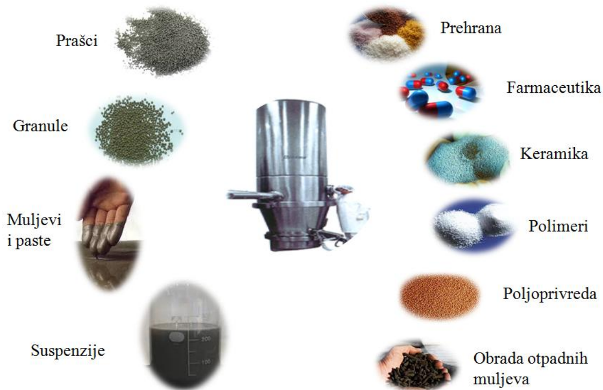
Slika 9. Industrijska primjena procesa s fluidiziranim slojem
