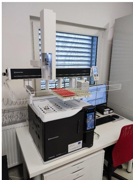
Slika 9. GC NEXIS GC-2030 s FID detektorom i headspace autosampler -om AOC 6000 Plus
