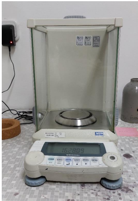
SLIKA 3.4. Analitička vaga AUW120
