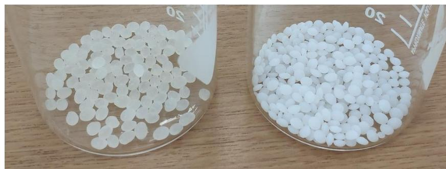
**Slika 10.** Sirovine PLA (lijevo) i PCL (desno)
