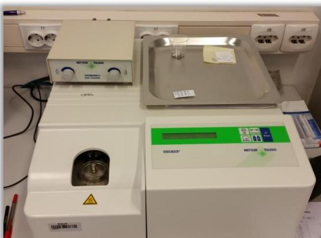
**Slika 14.** Fotografija diferencijalnog pretražnog kalorimetra Mettler Toledo 822
