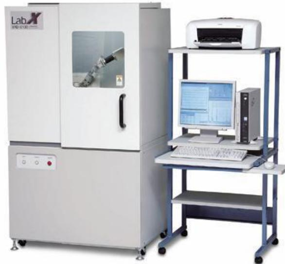
**Slika 18.** Fotografija difraktometra Shimadzu XRD 6000
