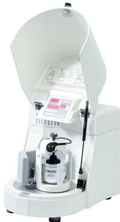
**Slika 9.** Fotografija planetarnog kugličnog mlina Pulversitte 6
