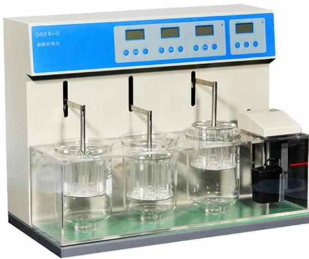
**Slika 20.** Fotografija uređaja za ispitivanje raspadljivosti tableta BJ 2
