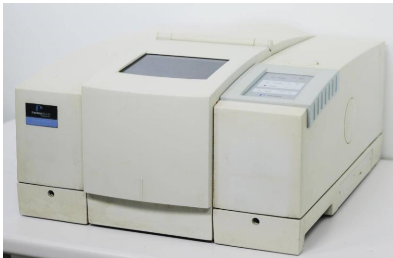
Slika 16. Fotografija FTIR spektrofotometra PerkinElmer Spectrum One (PerkinElmer, Waltham, Massachusetts, SAD)
