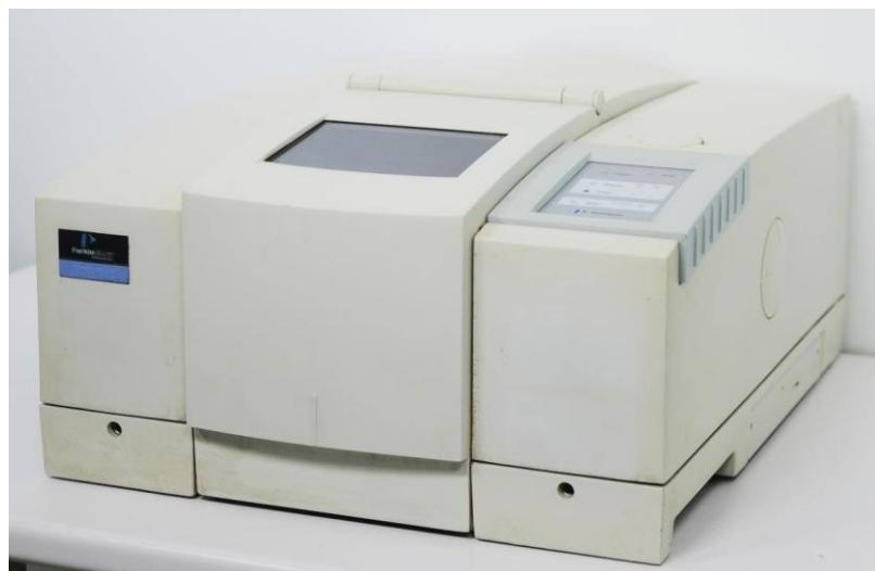
**Slika 16.** Fotografija FTIR spektrofotometra
