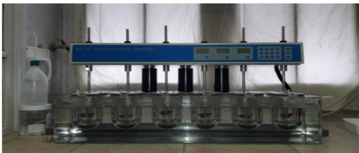
**Slika 22.** Fotografija uređaja za ispitivanje oslobođanja djelatne tvari RC-6D
