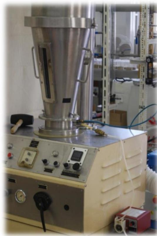
**Slika 11.** Fotografija granulatora s fluidiziranim slojem Uni-Glatt
