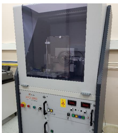
Slika 29. Difraktometar ItalStructures APD2000 dostupan u Zavodu za kemiju materijala, Instituta Ruđer Bošković
