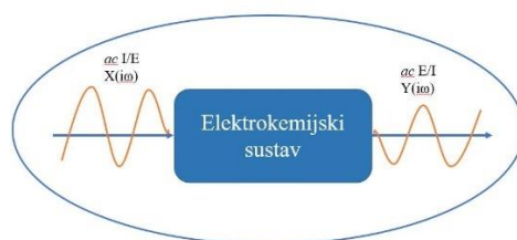
Slika 13. Shematski prikaz mjerenja elektrokemijske impedancijske spektroskopije, EIS
