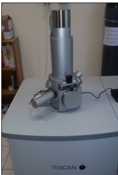
Slika 3.8. Elektronski mikroskop SEM-TESCAN VEGA TS5236LS
