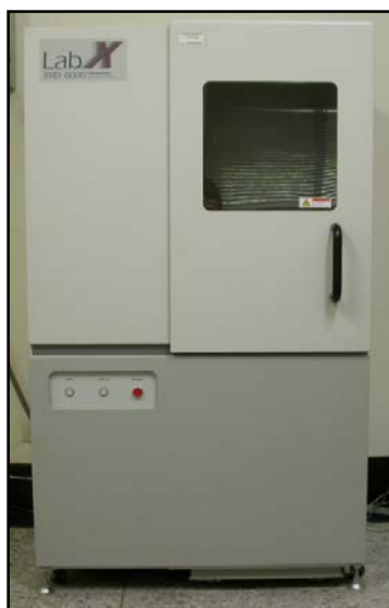
Slika 3.7. Uređaj za rendgensku difrakcijsku analizu, Shimadzu XRD-6000
