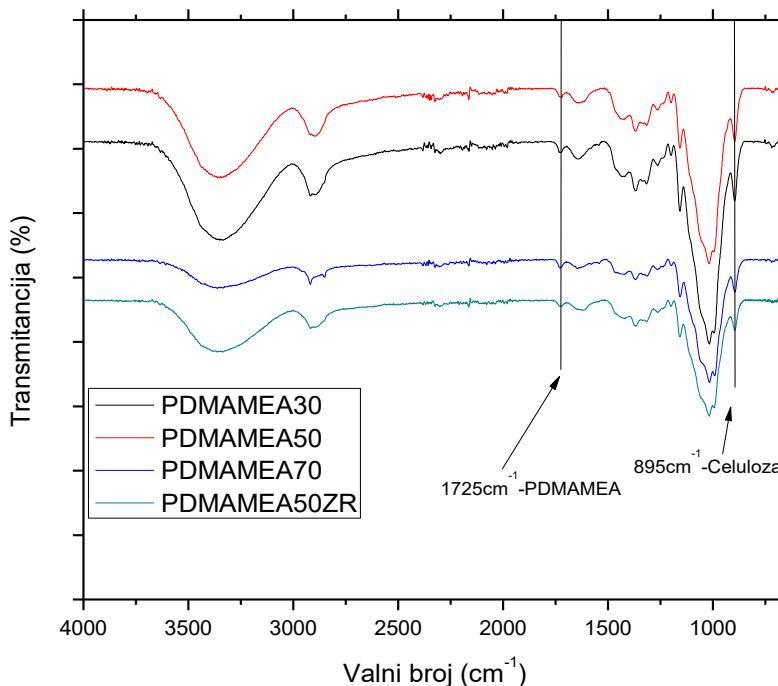
Slika 4.12 FTIR spektar PDMAMEA-celuloza hidrogelova geliranih 168 h
