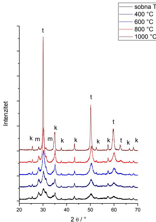
**Slika 16.** Difraktogrami praška mkA30 kalciniranog na navedenim temperaturama;
