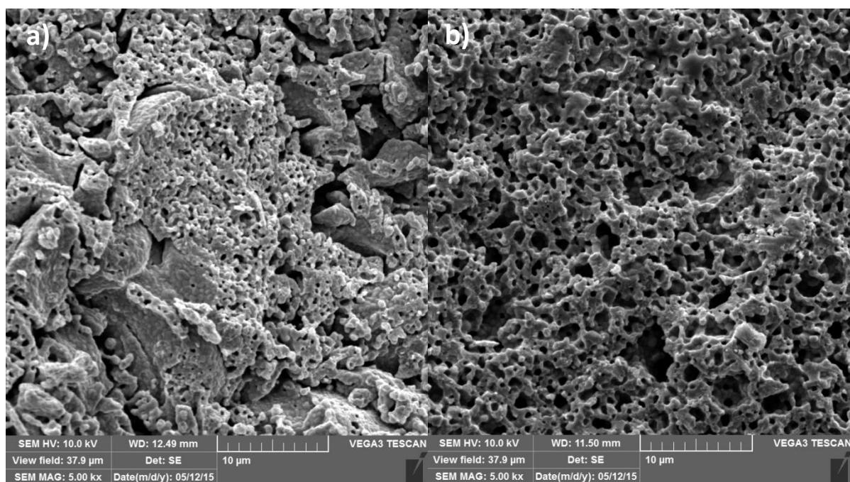
**Slika 24.** SEM mikrografija lomnih površina tableta a) sgZY, b) sgZYm, povećanje 5000 x
