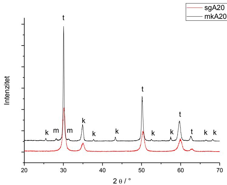
**Slika 18.** Difraktogrami prašaka mkA20 i sgA20 kalciniranih na 1000 °C; t – t-ZrO<sub>2</sub>, m – m-ZrO<sub>2</sub>, k – korund ( $\alpha$ - $\text{Al}_2\text{O}_3$ )
