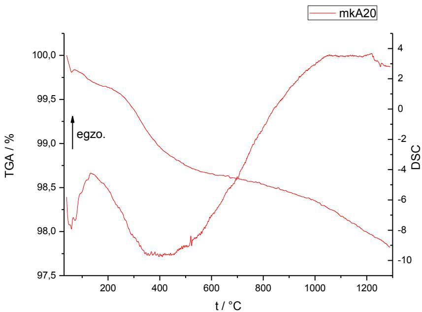
**Slika 23.** DSC i TGA krivulje uzorka mkA20
