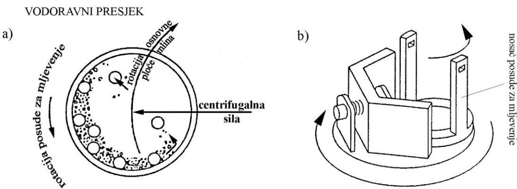
**Slika 6.** a) Posuda za mljevenje. Obilježen je smjer centrifugalne sile, te kretanje osnovne ploče mlinova, posude za mljevenje i kugli u posudi. b) Osnovna ploča mlinova<sup>22</sup>
