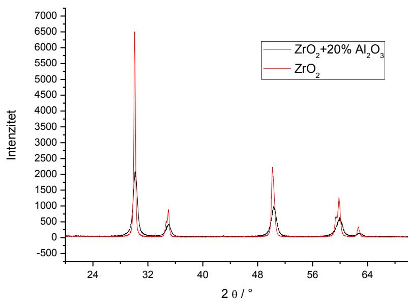
**Slika 13.** Difraktogram uzoraka sgZY i sgA20 kalciniranih pri  $1000\text{ }^{\circ}\text{C}$
