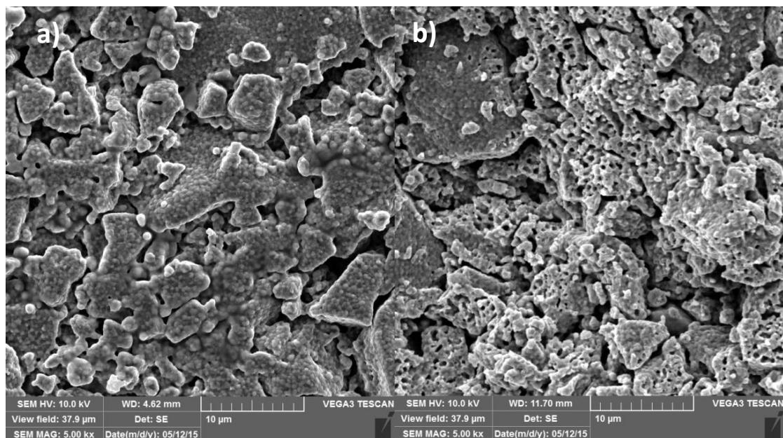
**Slika 26.** SEM mikrografija tableta sgA20m: a) površina tablete, b) lomna površina; povećanje 5000 x
