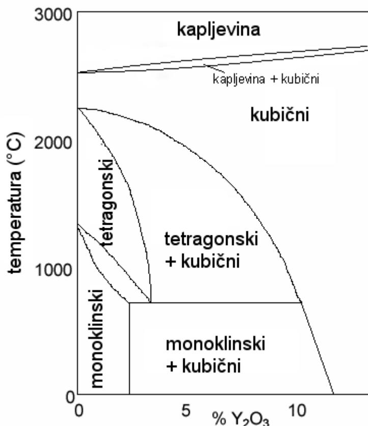
Slika 2. Fazni dijagram ZrO<sub>2</sub> i Y<sub>2</sub>O<sub>3</sub>
