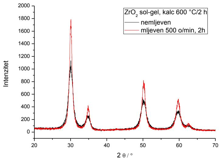
**Slika 11.** Difraktogram uzorka sgZY i sgZYm žarenih na  $600^\circ\text{C}$
