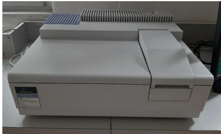
**Slika 8.** UV/VIS spektrofotometar Perkin Elmer LAMBDA 35
