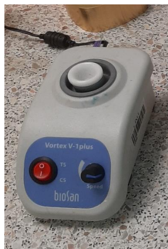
Slika 3.2. Homogenizator Vortex V-1 plus (Biosan, Latvija)
