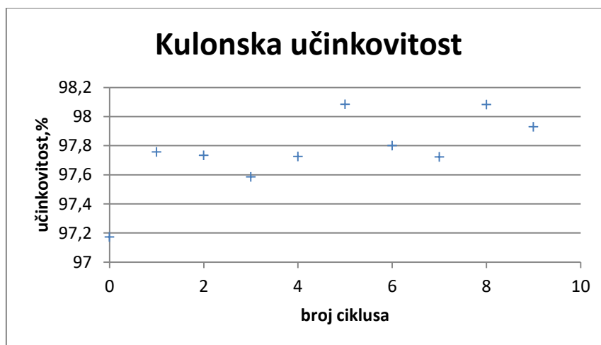
Slika 4.10. Kulonska učinkovitost dobivena kroz 10 ciklusa punjenja i pražnjenja strujom C=0,074 nakon degradacije članka.
