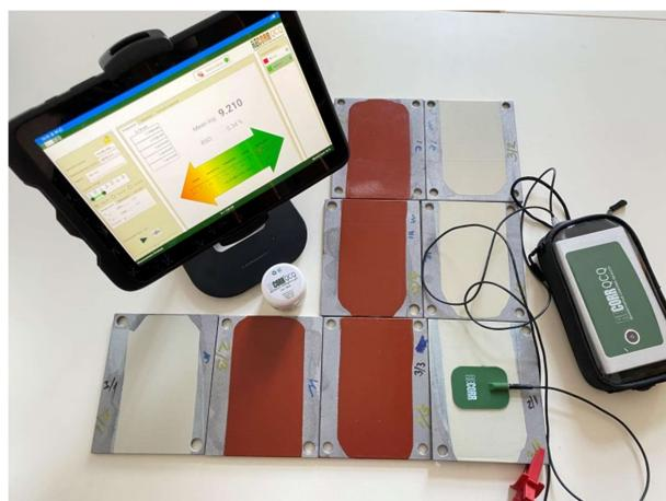
Slika 3.9 Prikaz mjerena elektrokemijske impedancijske spektroskopije s ReCorr QCQ uređajem uz pripadajući tablet, vodljivu pastu, fleksibilnu elektrodu i žice
