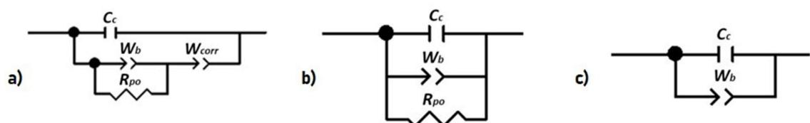
Slika 2.6 Ekvivalentni električni krugovi za premaz u različitim fazama sušenja:
