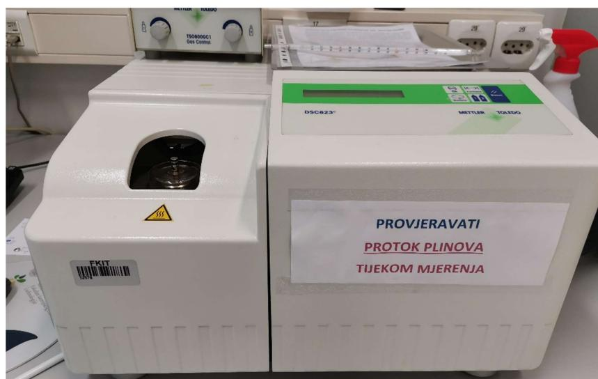
Slika 3.7 DSC uređaj Mettler Toledo DSC 823e
