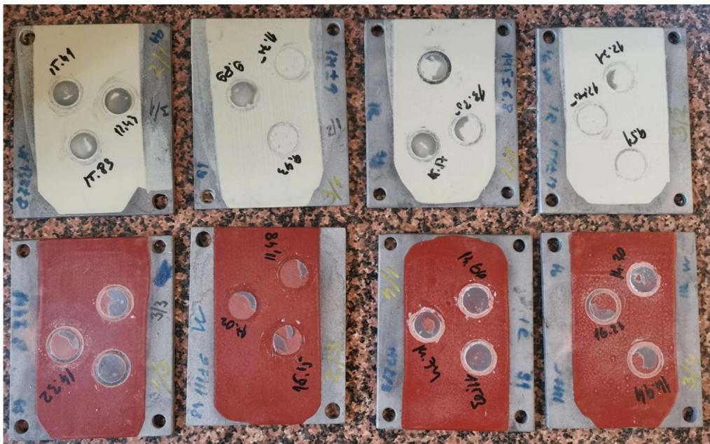
Slika 4.11 Korištene pločice za mjerjenje prionjivosti premaza na metalnoj površini
