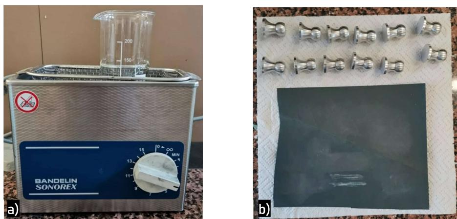
Slika 3.10 Priprema čunjića za mjerjenje prionjivosti: a) odmašćivanje u etanolu na ultrazvučnoj kupelji i b) obrada brusnim papirom granulacije 800
