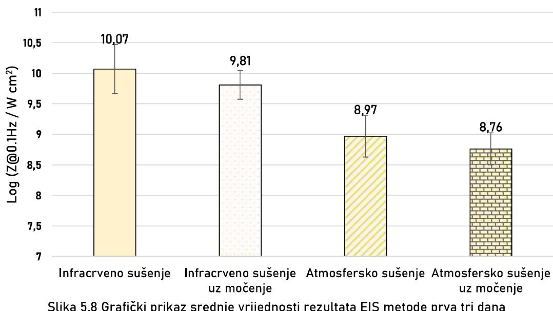
Slika 5.8 Grafički prikaz srednje vrijednosti rezultata EIS metode prva tri dana za prehodno močen premaz Hempadur Mastic 4588W
