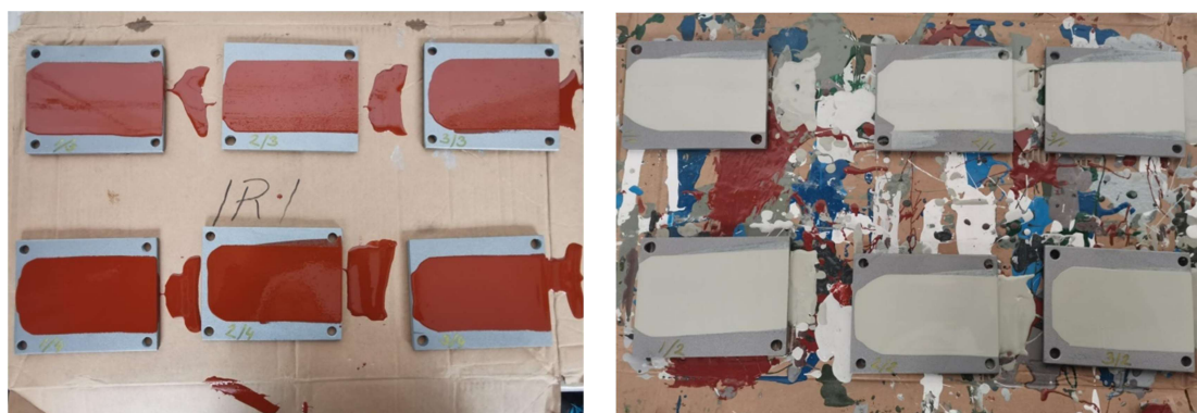
Slika 3.4 a) Pločice s nanesenim slojem premaza Hempaprime Multi 500 i b) pločice s nanesenim slojem premaza Hempadur Mastic 4588W
