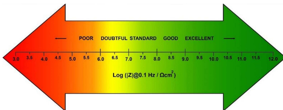
Slika 5.4 Kategorije za procjenjivanje djelotvornosti premaza ovisno o rezultatu QCQ uređaja
