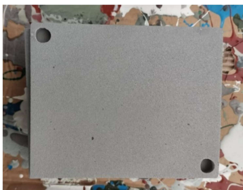
Slika 3.1 Sačmarene pločice na koje se nanose uzorci premaza
