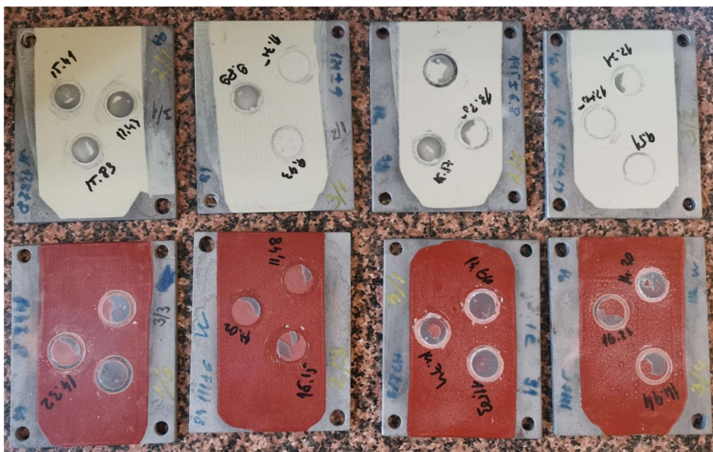
Slika 4.11 Korištene pločice za mjerenje prionjivosti premaza na metalnoj površini
