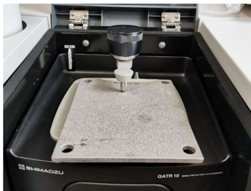
Slika 3.8 Prikaz položaja pločice s uzorkom u FTIR-ATR uređaju
