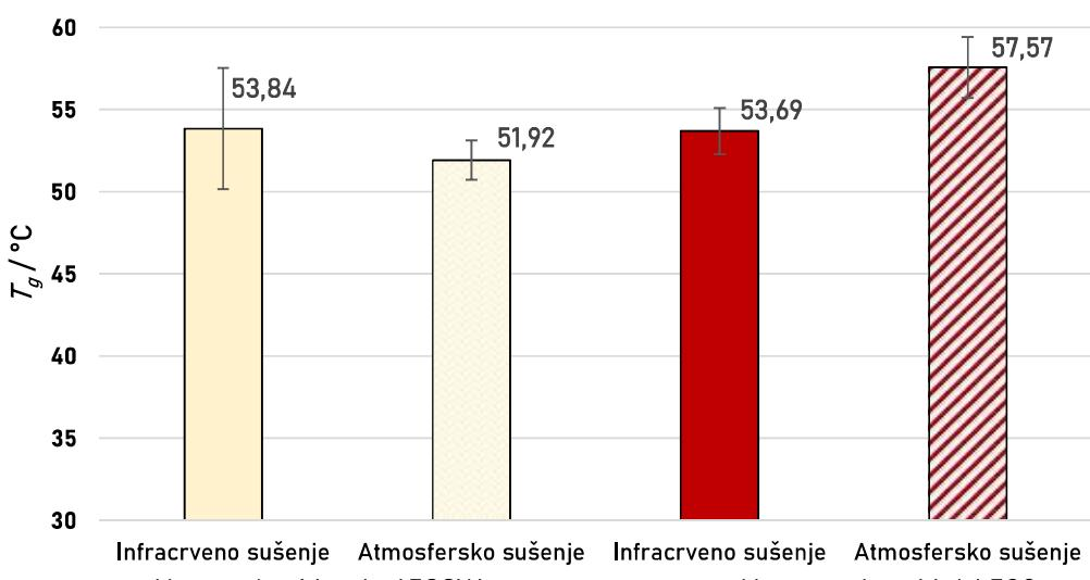
Slika 5.1 Grafički prikaz srednje vrijednosti 9. i 21. dana staklišta Hempadur Mastic 4588W i Hempaprime Multi 500 premaza za atmosfersko i infracrveno sušenje
