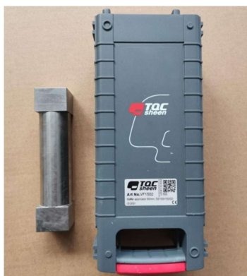
Slika 3.3 Baker aplikator za nanošenje premaza, 80 mm, 50/100/150/200, TQC sheen
