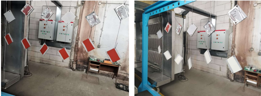
Slika 3.5 Način postavljanja uzoraka u peć za sušenje s infracrvenim zračenjem
