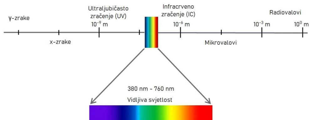
Slika 2.1 Elektromagnetski spektar s istaknutim vidljivim dijelom spektra
