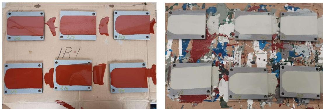
Slika 3.4 a) Pločice s nanesenim slojem premaza Hemppaprime Multi 500 i
