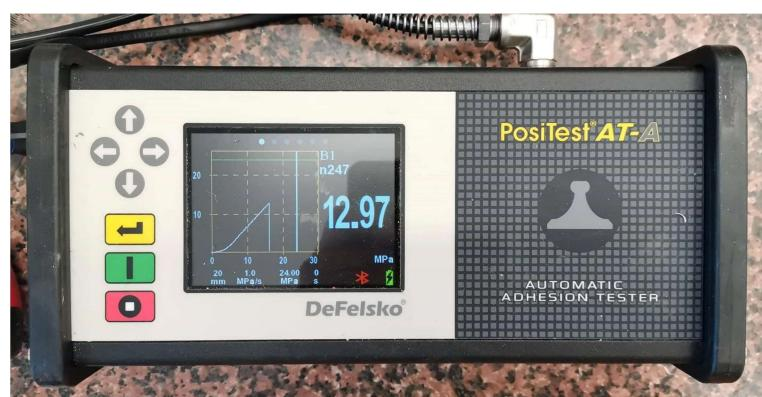
Slika 3.11 Uređaj PosiTet ATA za ispitivanje prionjivosti vlačnom metodom
