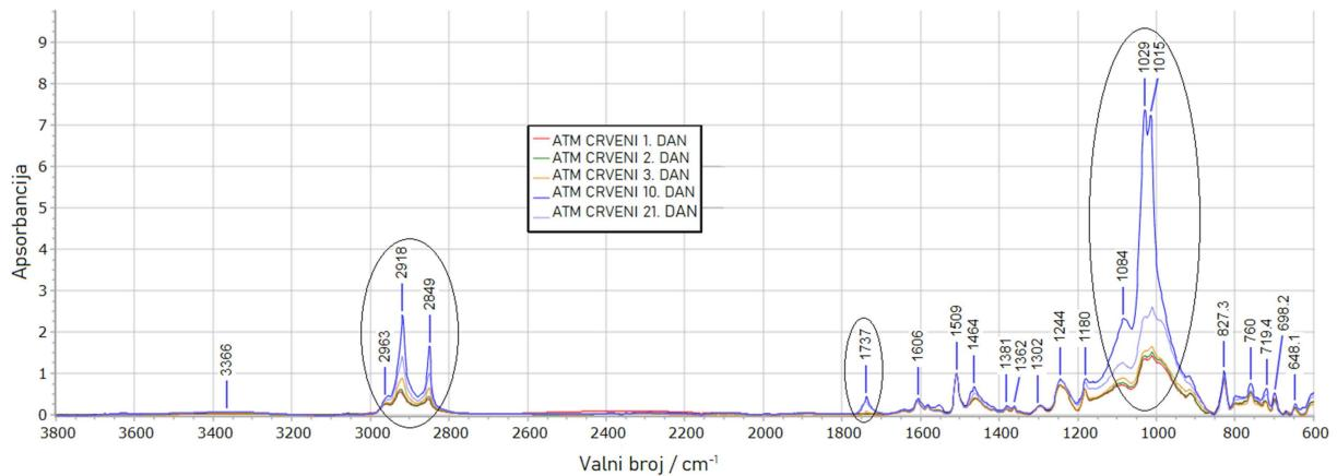
Slika 4.4 Spektrogram dobiven FTIR analizom tijekom 21 dan za premaz Hempaprime Multi 500 koji je atmosferski sušen
