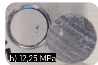
Slika 4.13 Površina čunjića i premaza nakon mjerena prionjivosti
