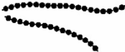
Slika 2. Shematski prikaz linearnih makromolekula
