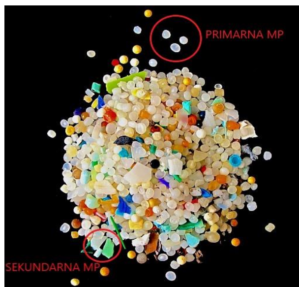
Slika 2. Morfološka razlika između primarne i sekundarne mikroplastike. 8
