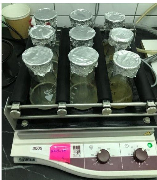
Slika 11. Tikvice s odgovarajućom kombinacijom čimbenika postavljene na rotacijsku tresilicu.
