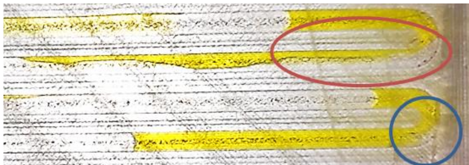
Slika 56 Pojava razlijevanja segmenata (zaokruženo crveno) i stvaranja džepova (zaokruženo plavo)
