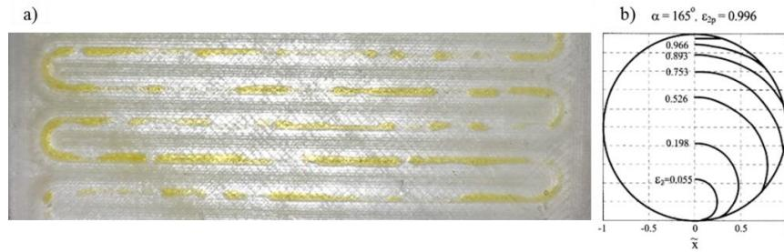
**Slika 59 a)** Prikaz prijelaznog strujanja u reaktoru s cijevi promjer 1,5 mm b) obik međufazne površine pri paralelnom strujanju za  $Bo \approx 1$  te veliki kontaktni kut kapljivine s površinom. [33]
