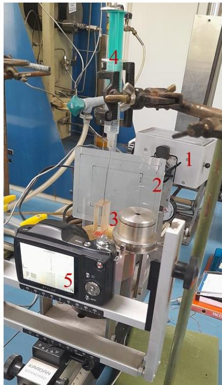
**Slika 18.** Aparatura za mjerjenje kontaktnog kuta i međupovršinske napetosti. 1 - izvor svjetla 2 - raspršivač svjetla, 3 - kvarcna kiveta 4 - sprica s kapilarom 5 - fotoaparat
