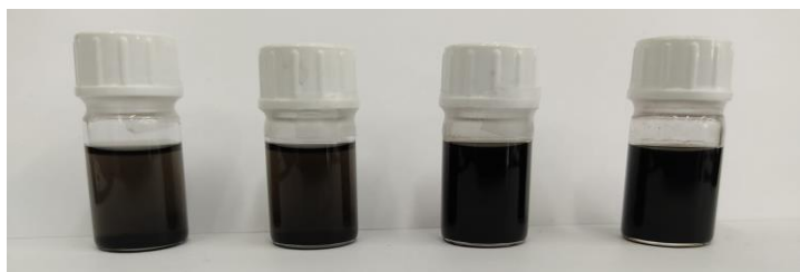
Slika 16. Druga serija disperzija MWCNT (redom 1.1-4.1); a) odmah nakon miješanja, b) 2 sata nakon miješanja, c) mjesec dana nakon miješanja
