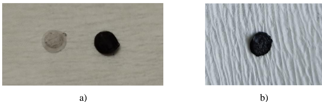
Slika 25. a) Dobro napravljena membrana bez i sa čvrstim kontaktom, b) membrana i čvrsti kontakt kroz koji su prodrijeti mjehurići
