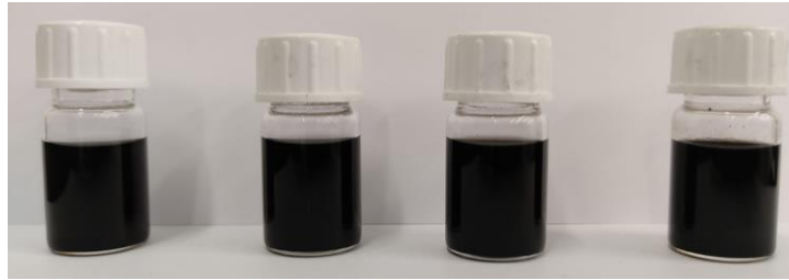
Slika 15. Druga serija disperzija MWCNT (1.1-4.1) na dan pripreme
