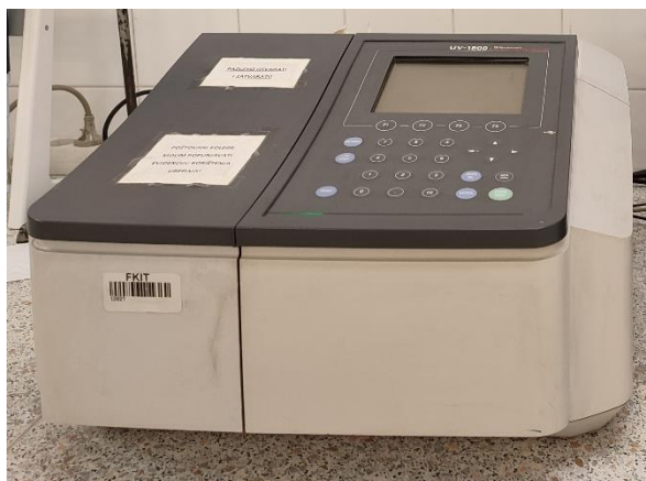
Slika 3.5. Spektrofotometar Shimadzu UV-1800
