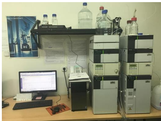
Slika 3.4. HPLC instrument SHIMADZU
