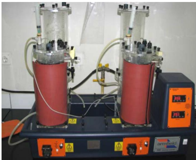
Slika 3.4. Fotografski snimak uređaja za anerobnu digestiju.
