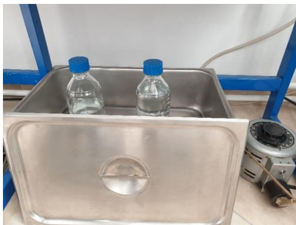
Slika 8. Otapanje KOH u metanolu u ultrazvučnoj kupelji
