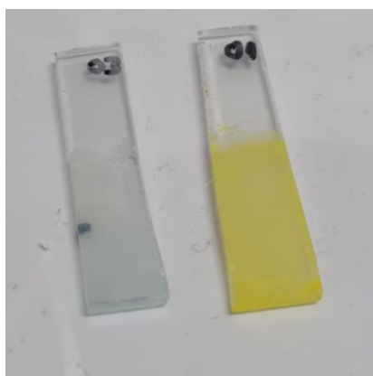
Slika 3.7. \text{WO}_3 fotoelektroda (lijevo); \text{WO}_3/\text{BiVO}_4 fotoelektroda dvoslojne strukture (desno)
