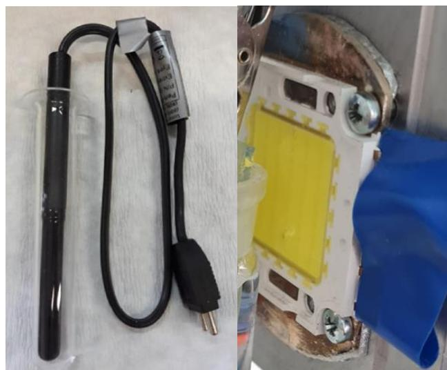
**Slika 3.2.** UV lampa (lijevo); LED lampa (desno) korištene tijekom fotoelektrokemijskih
