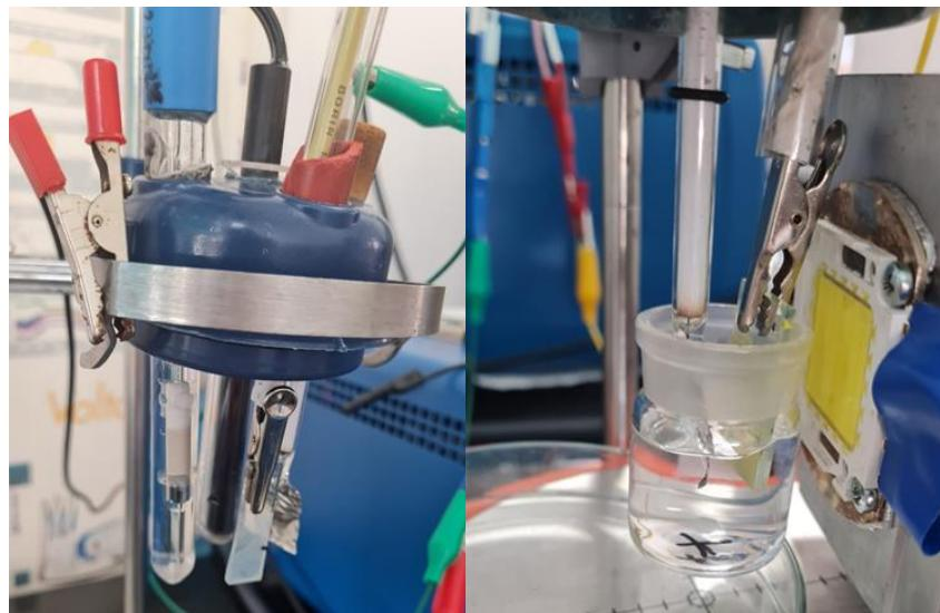
**Slika 3.1.** Troelektrodnji sustav korišten za karakterizaciju fotoelektroda (lijevo);
