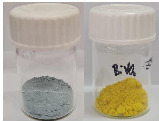
**Slika 3.6.** WO<sub>3</sub> prah (lijevo); BiVO<sub>4</sub> prah (desno)
