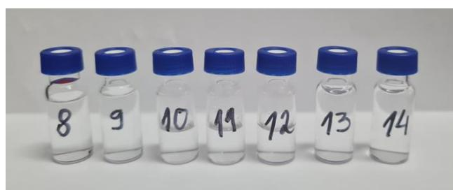
**Slika 3.8.** Uzorci otopina amoksicilina za HPLC analizu
