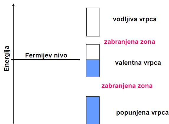
**Slika 2.8.** Shematski prikaz energijskih vrpci u čvrstom tijelu (metalu) [21]
