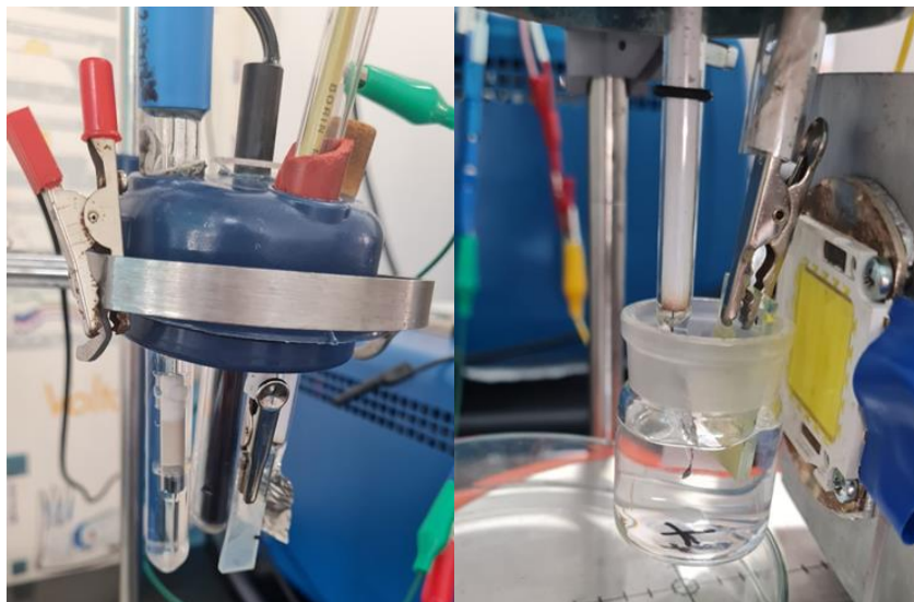
Slika 3.1. Troelektrodni sustav korišten za karakterizaciju fotoelektroda (lijevo); dvoelektrodni sustav korišten za provođenje fotoelektrokatalize (desno)
