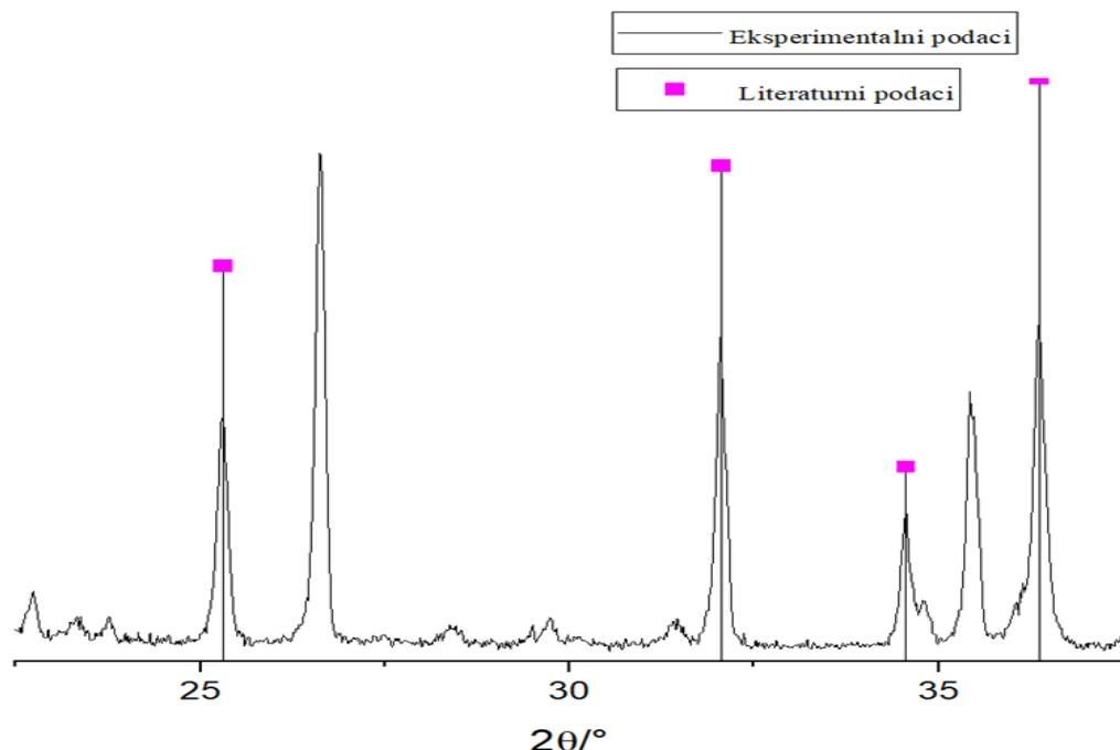
Slika 31: Difraktogram za uzorak P-1-184 eksperimentalno dobiveni podaci mjerena uspoređeni s literaturnim podacima
