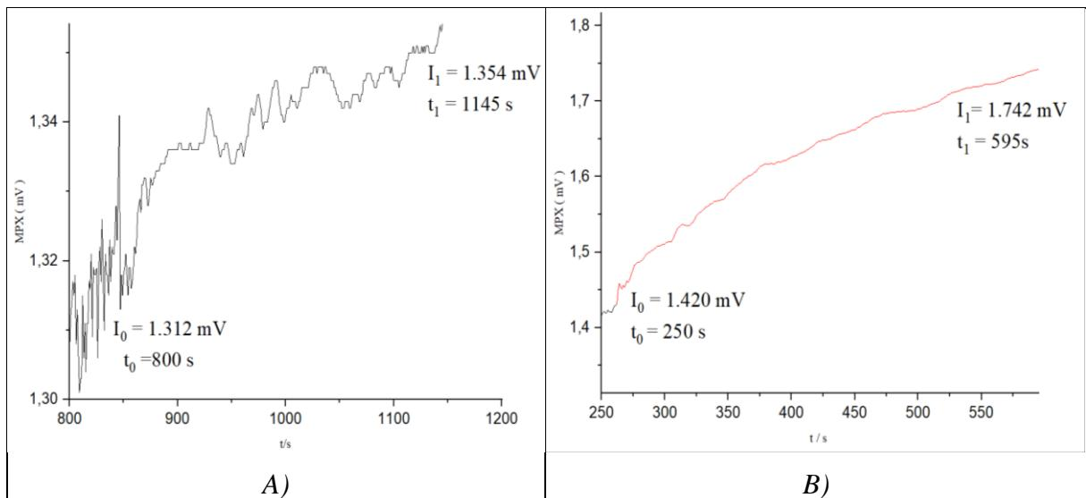
Slika 68: Uvećane sedimentacijske krivulje (sirovi podaci) u vremenskom intervalu,  $\Delta t = 345 \text{ s}$ , u svrhu uspoređivanja dobivenih krivulja za uzorak :
