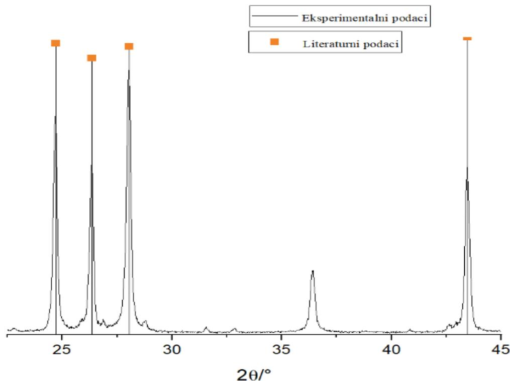
Slika 30: Difraktogram za uzorak SW-1, eksperimentalno dobiveni podaci mjerena uspoređeni s literaturnim podacima
