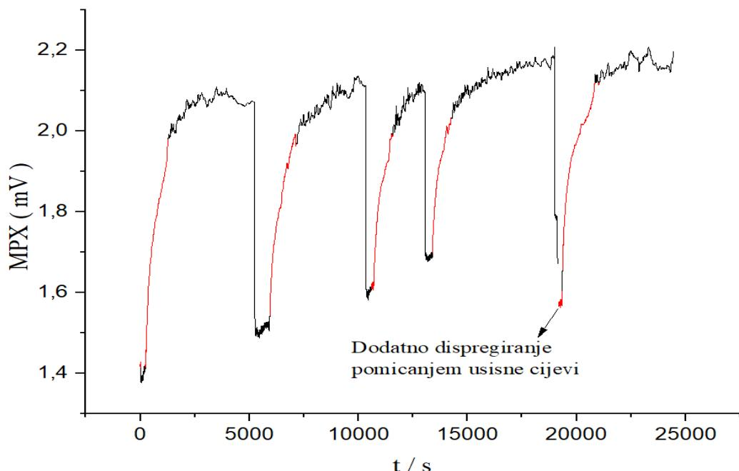
Slika 65: Prikazani su sirovi podaci mjerena, na kojima se uočavaju sedimentacijske krivulje(označene crvenom bojom) dobivene dodavanjem inkrementalnih dodataka točno definirane mase za uzorak  $\text{Al(OH)}_3$ . Sedimentacija se provodi 8h, svrhu komentiranja ponovljivosti rezultata. Šumovi na grafu ukazuju na rad pumpe, a svaka stepenica prikazuje dodavanje inkrementalnog dodatka.
