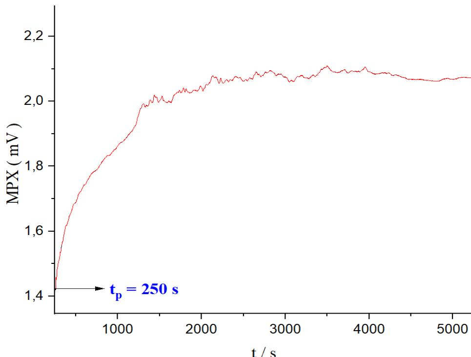
*Slika 69: Primjer određivanja Stokesovog promjera,  $d_{St}$  ( $\mu\text{m}$ ) na temelju sedimentacijske krivulje (označena crvenom bojom). Vrijeme sedimentacije iznosi 5000 s, a početak sedimentacije počinje pojavom prvog signala. Metoda određivanja prvog signala prikazana je na Slici 59, a vrijednosti dobivenih signala upisani su u Tablici 10.*
