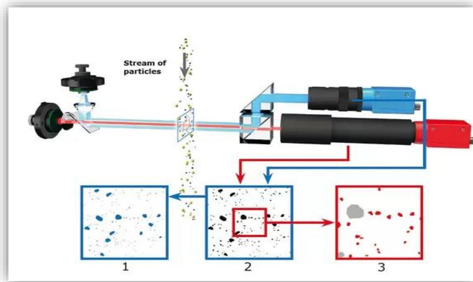
Slika 2: Shematski prikaz uređaja dinamičke analize slike (DIA)
