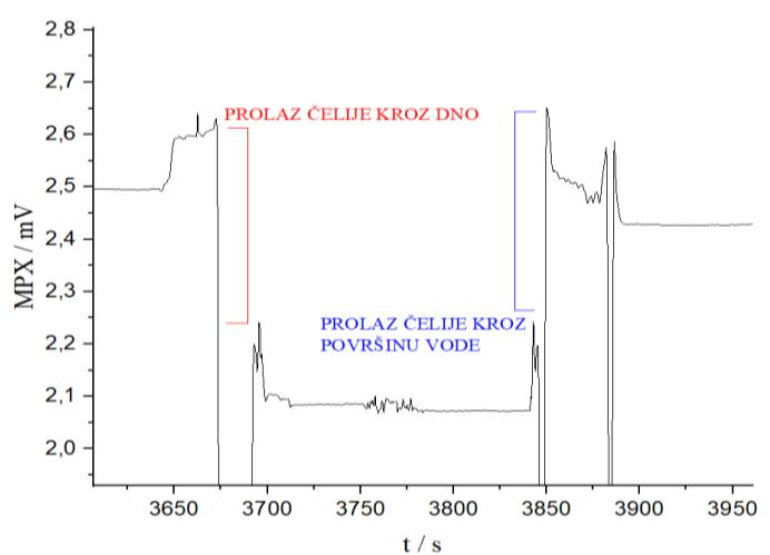
*Slika 51 : Promjena dubine suspenzije uzorka koji se ispituje, pomicanjem kivete sa suspenzijom prema gore i/ ili dolje koristeći dostupan labaratorijski uređaj za pripravu tankih filmova .Prikazani pikovi prikazuju promjenu intenziteta prolaskom čelije kroz dno i prolaskom čelije kroz površinu vode.*
