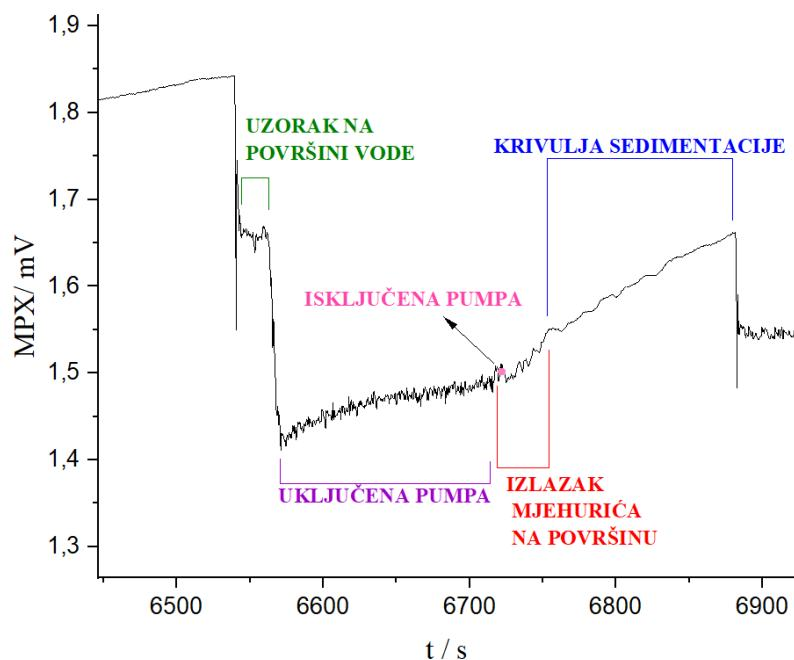
Slika 58: Detalj sirovih podataka, prikazuje odziv signala prilikom dodavanja uzorka  $\text{Al(OH)}_3$  koji odredeno vrijeme pluta na površini suspenzije prije nego se dispregrira, i sedimentacijsku krivulju. Problem nastajanja mjehurića zbog rada pumpe.
