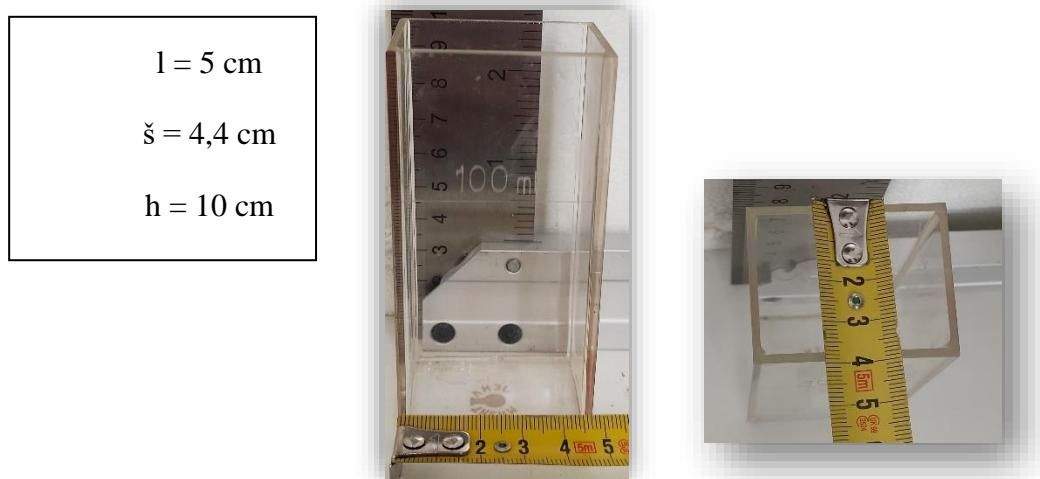
Slika 33: Prikaz mjerne čelije sa zadanim dimenzijama
