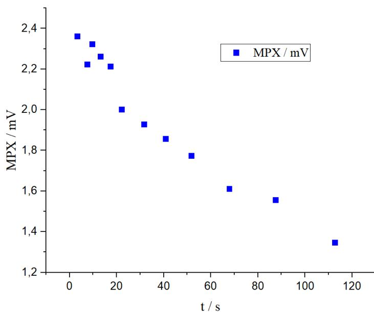
Slika 60: Baždarni dijagram za uzorak  $\text{Al}(\text{OH})_3$  na temelju sirovih podataka iz Tablice 10.
