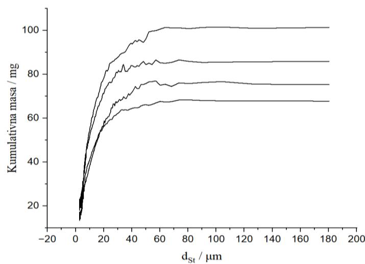
*Slika 72:* Kumulativne krivulje za uzorak Al(OH)<sub>3</sub> dobivene sedimentacijskim testom. (*Slika 65*)
