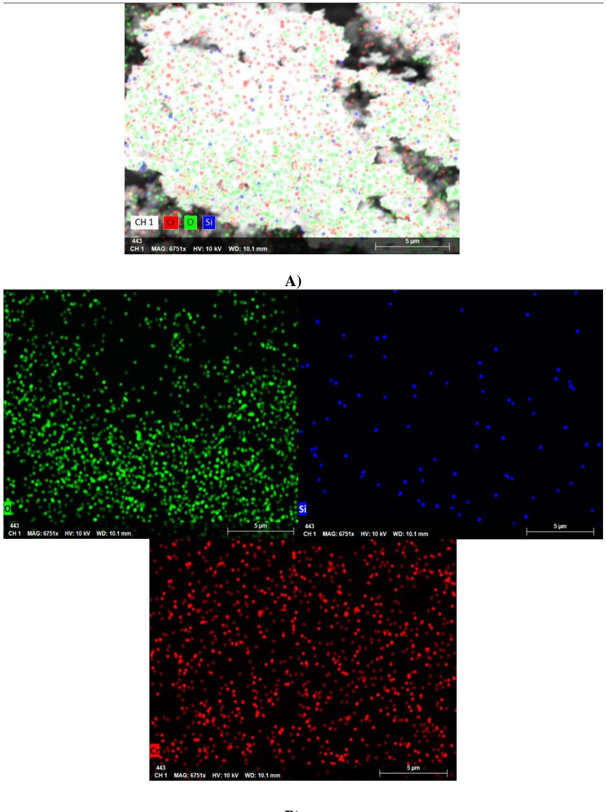
Slika 23: Mikrografi: A) Uzorak  $\text{Cr}_2\text{O}_3$  dobivena EDS-om
