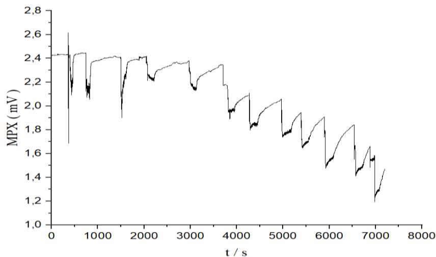
Slika 57: Primjer baždarenja (sirovi podaci) za uzorak  $\text{Al(OH)}_3$ , pri čemu je dodano 12 inkrementalnih dodataka. Nakon dodavanja prve odvage nastaje suspenzija, određene koncentracije, a svaki pik na grafu predstavlja inkrementalni dodatak.
