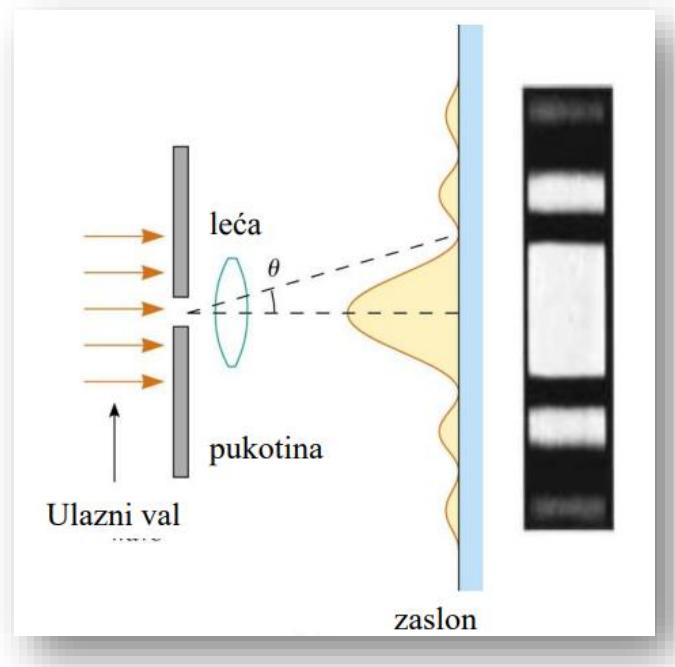
Slika 8: Shematski prikaz Fraunhoferova difrakcija (difrakcija paralelnih svjetlosnih valova) – događa se kada je izvor svjetlosti beskonačno udaljen od prepreke (otvora) na kojoj se obavlja difrakcija.
