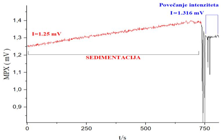
Slika 61: Prikaz sedimentacije za uzorak BEDEK-185. Prvih 750 s prikazuje suspendiranje uzorka pumpom, pri čemu dolazi do sedimentacije čestica koja je označena na grafu. Nakon 750 sekunde je talog dispergiran, te je došlo do smanjenja intenziteta signala.
