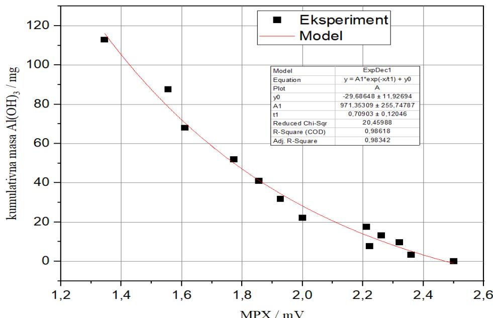
*Slika 71:* Matematički model dobivanja ovisnosti kumulativne mase Al(OH)<sub>3</sub> o naponu fotodetektora, mase izvornog skupa čestica koje daju isti signal kao u vremenu stvarne sedimentacije - γ. Matematički model ne opisuje savršeno eksperimentalno dobivene vrijednosti, vidljiva su odstupanja pojedinih točaka.
