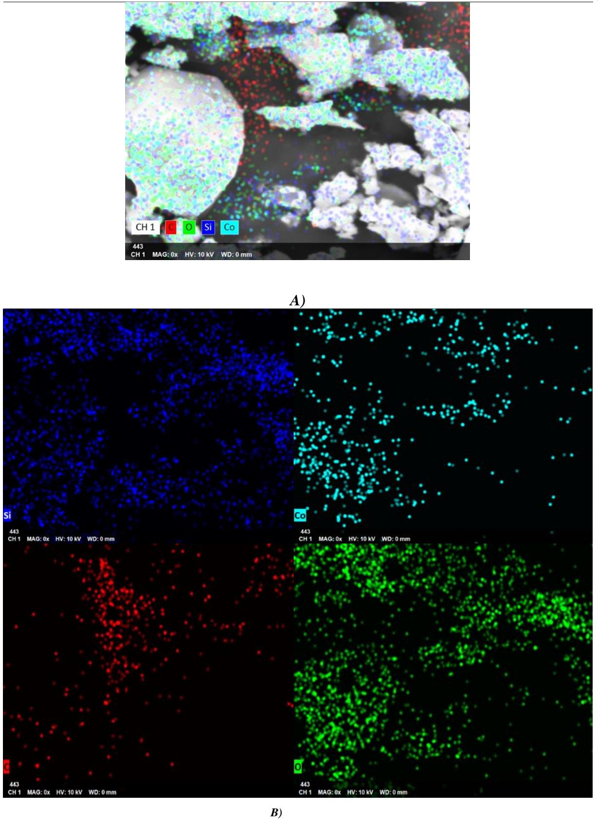
Slika 24: Mikroografi: A) Uzorak P-1-184 dobivena EDS-om
