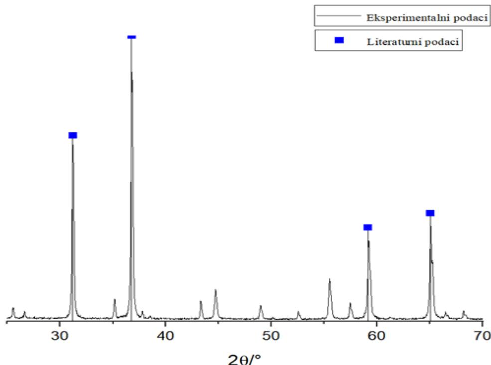
Slika 29: Difraktogram za uzorak BEBEK-185, eksperimentalno dobiveni podaci mjerjenja uspoređeni s literaturnim podacima.
