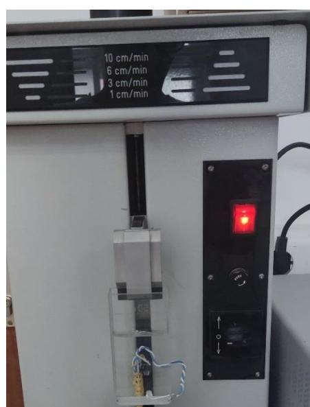
Slika 39: Mjerna čelija prikvačena na uređaj za izradu tankih filmova
