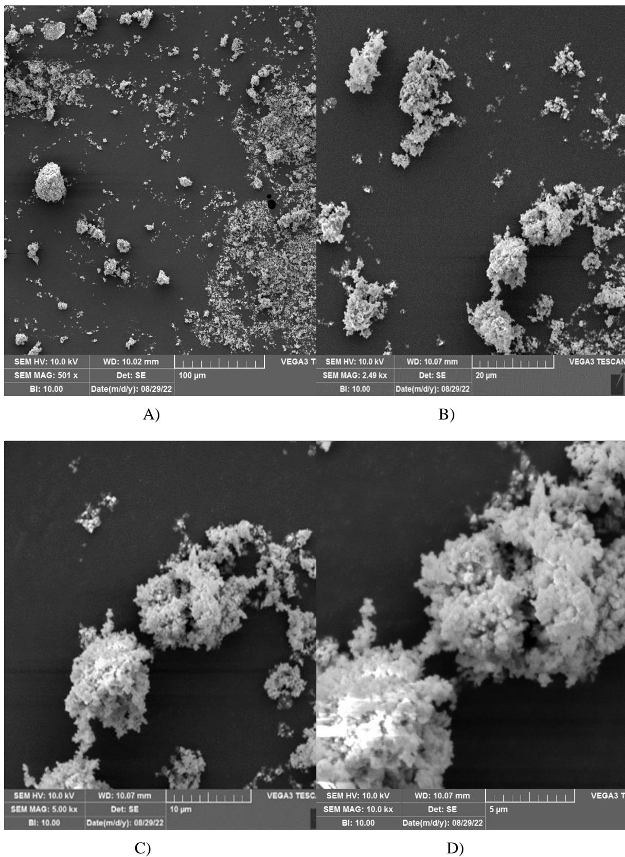
Slika 19: Mikrografii A), B), C) i D) dobivene SEM metodom za uzorak  $\text{Cr}_2\text{O}_3$
