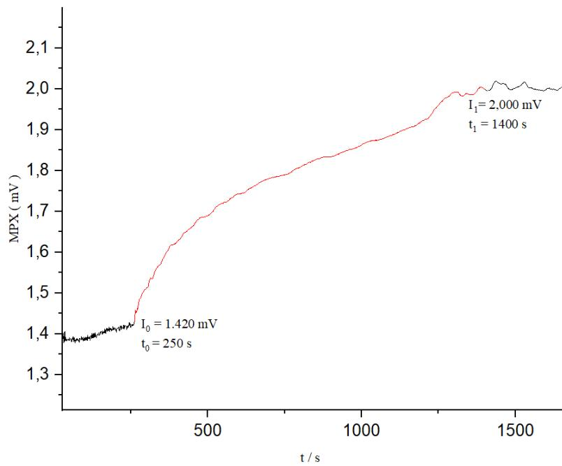
Slika 67: Uvećana krivulja sedimentacije (označena crvenom bojom) za uzorak  $\text{Al}(\text{OH})_3$ . Graf prikazuje sirove podatke, te skok intenziteta uzrokovani taloženjem čestica za vremenski interval  $\Delta t = 1150 \text{ s}$ .
