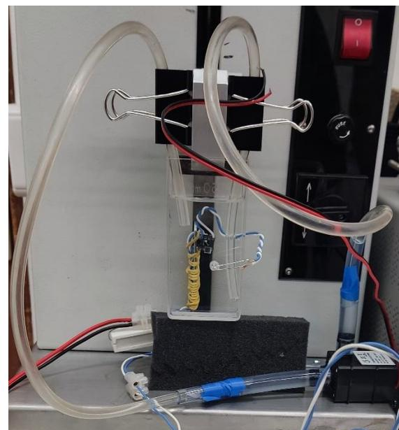
Slika 41: Cjevi pumpe priključene na izvor, postavljene u mjernu čeliju u svrhu postizanja bolje disperzije
