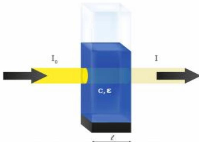
Slika 9: Shematski prikaz Lambert – Beerova zakona: Omjer upadnog i izlaznog intenziteta je određen duljinom puta svjetlosti kroz sredstvo ( $l$ ) i koncentraciji tvari  $c$ . Prilikom prolaska svjetlosti kroz tvar dio svjetlosti se apsorbira, što je određeno molarnim apsorpcijskim koeficijentom,  $\epsilon$ .
