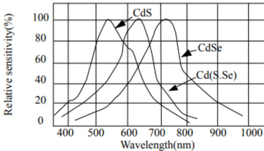
Slika 74: Spektralna osjetljivost senzora ovisno o valnoj duljini ( $\lambda/\text{nm}$ ) za tri različita fotodetektora (CdS, CdSe, Cd (S.Se))
