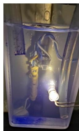
Slika 62: Mjerna čelija kod koje se u donjem lijevom kutu dogodila nepoželjna sedimentacija, koja je također prikazana na grafičkom prikazu, (Slika 60). Desna cijev izlazi iz pumpe, a lijeva cijev je dozira, tj. povrat suspenzije u pumpu.
