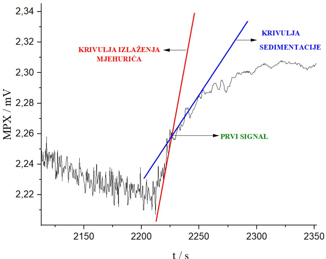
*Slika 59: Primjer određivanja intenziteta signala sirovih podataka za suspenziju  $\text{Al(OH)}_3$ , pripravljen nizom inkrementalnih dodataka. Plavi pravac je povučen na krivulju sedimentacije, dok crveni pravac je povučen na krivulju izlaženja mjehurića. Sjecište tih dvaju pravaca daje vrijednost promjene signala.*
