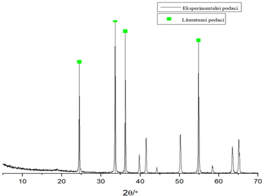
Slika 32: Difraktogram za uzorak  $\text{C}_2\text{O}_3$  eksperimentalno dobiveni podaci mjerena uspoređeni s literaturnim podacima
