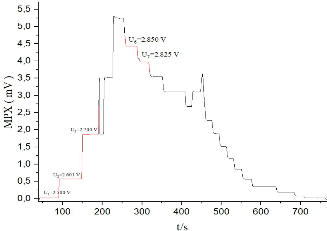
Slika 52: Odziv fotodetektora o različitim vrijednostima napona. Svaka stepenica na grafu predstavlja drugu vrijednost napona , napajanja led diode (izvor bijele svjetlosti). Vrijednosti napona se kreću od manje prema većoj, do postizanja maksimuma, te se ponovno kreću od veće prema manjoj. Graf prikazuje sirove podatke mjerena.
