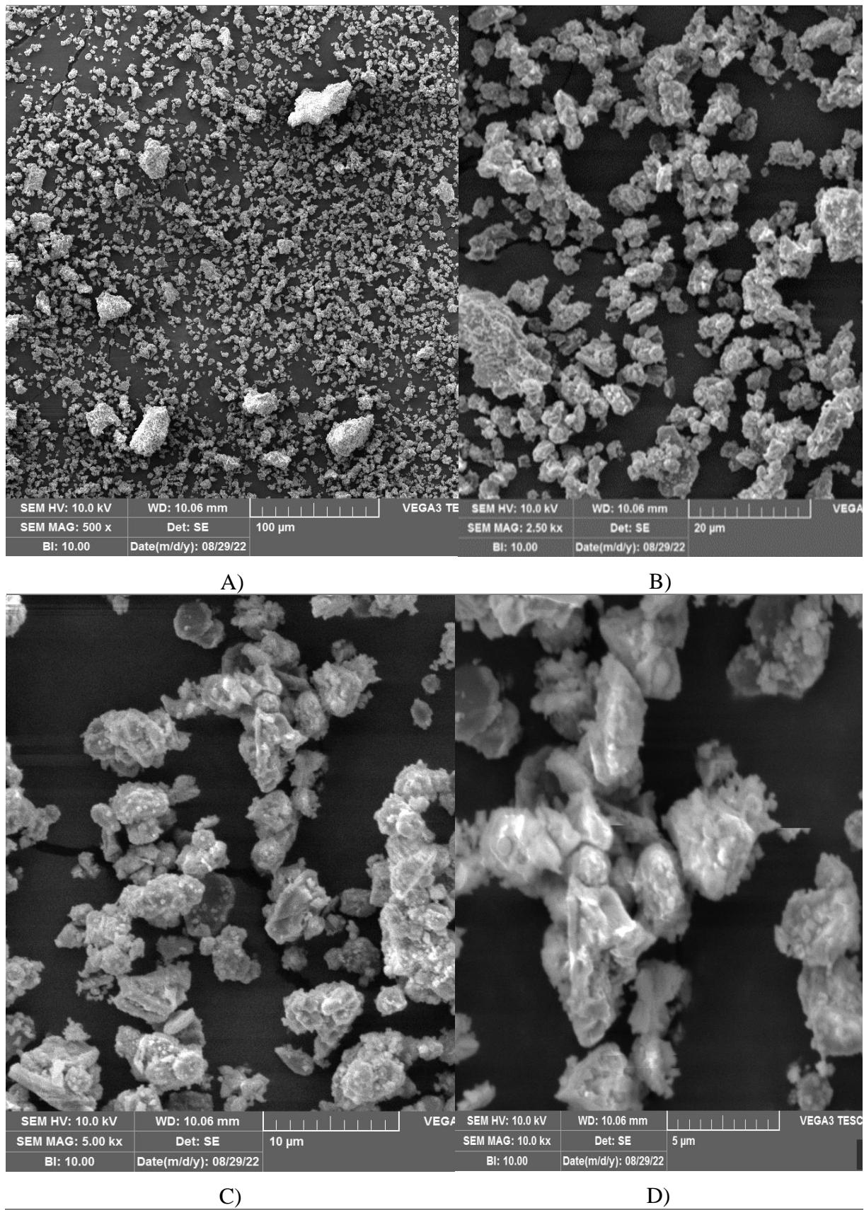
Slika 18: Mikrografi A), B), C) i D) dobivene SEM metodom za uzorak 185-BEDEK
