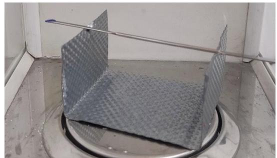
Slika 48: Princip vaganja i određivanja mase ispitivanih uzoraka
