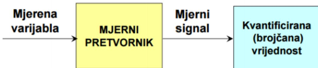
**Slika 2-1.** Shema rada mjernog pretvornika
