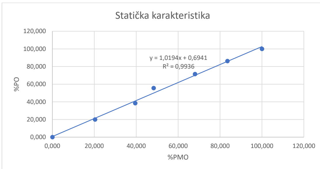
Slika 4-2. Statička karakteristika mjernog pretvornika
