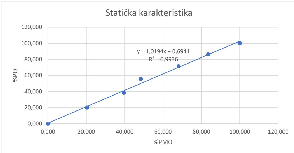
**Slika 4-2.** Statička karakteristika mjernog pretvornika
