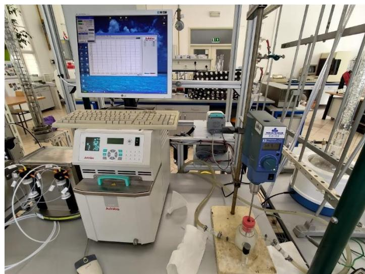
**Slika 28.** Aparatura za određivanje topljivosti
