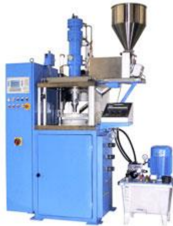
Slika 6. Prikaz klipnog ekstrudera
