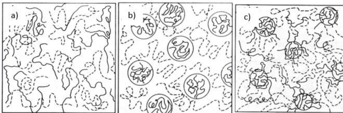
Slika 11. Prikaz struktura a) potpuno mješljivih mješavina b) nemješljivih i c) djelomično mješljivih mješavina [25]
