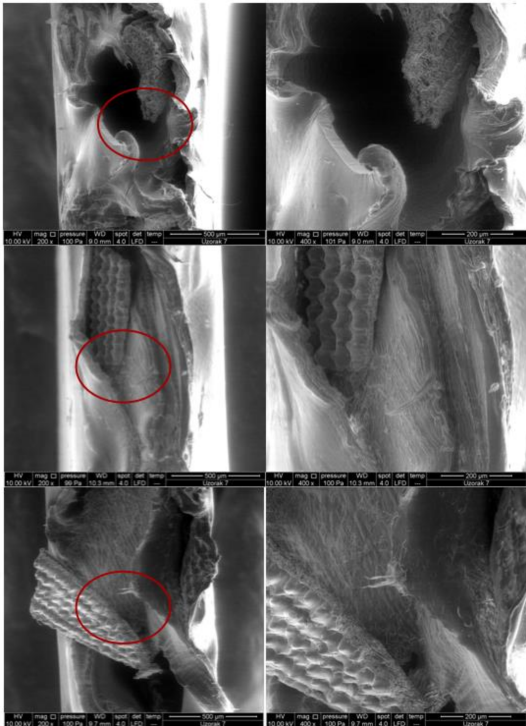
Slika 53. SEM mikrografije LLDPE/RLJ 90/10 biokompozita bez dodatka mTiO 2 : uvećanje 200x i 400x - prikaz oblaganja unutarnje strane stijenke vlakna RLJ.
