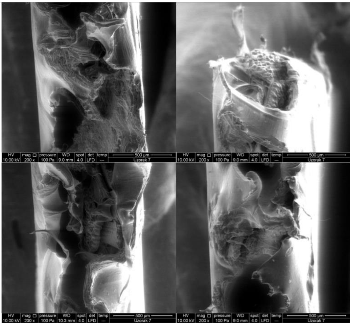
Slika 51. SEM mikrografija LLDPE/RLJ 90/10 biokompozita bez dodatka m \text{TiO}_2 : uvećanje 200x.
