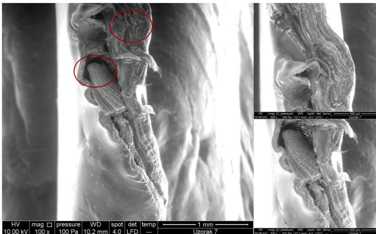
Slika 54. SEM mikrografije LLDPE/RLJ 90/10 biokompozita bez dodatka mTiO_2 : uvećanje 100x i 200x - prikaz vlakana RLJ prilikom otvaranja stijenke biokompozita.
